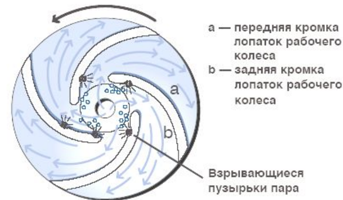
Рис. 2.2.9: Взрыв кавитационных пузырьков на задней стороне лопаток рабочего колеса
