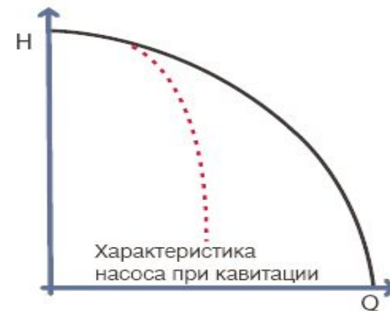
Рис. 2.2.11: Характеристика насоса при кавитации
