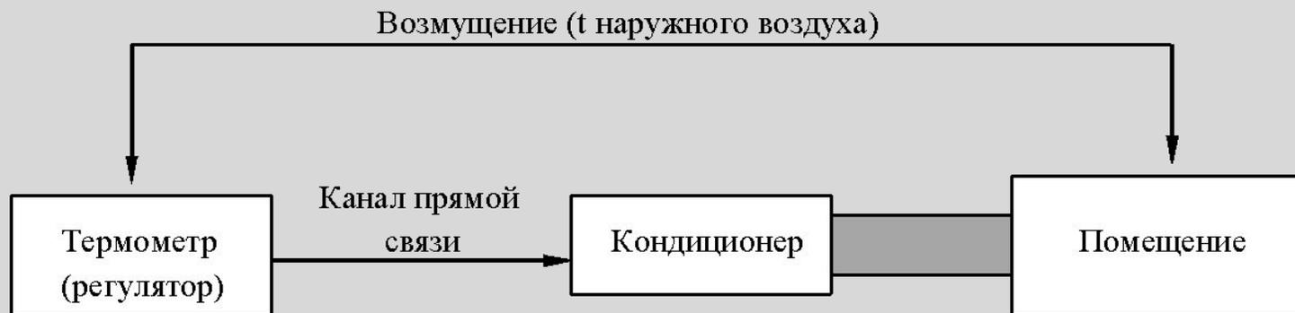
Рис 2. Пример блок-схемы разомкнутой системы
