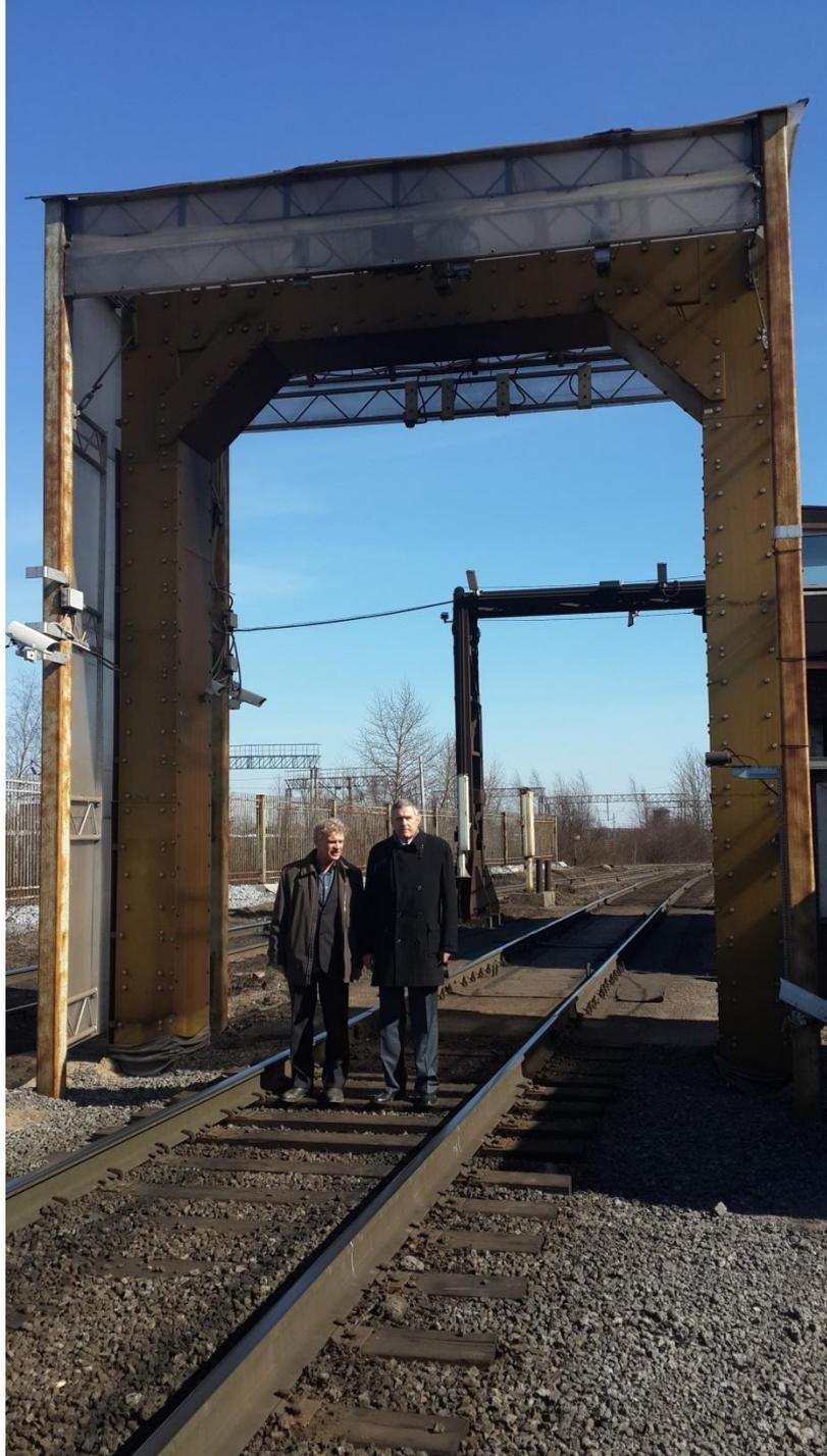
**Катушки бывают разные. Например, такие, через которые ездят железнодорожные вагоны. В данном случае катушка создана группой компаний АМТ&С и использовалась для определения количества металлолома в движущемся вагоне.**
