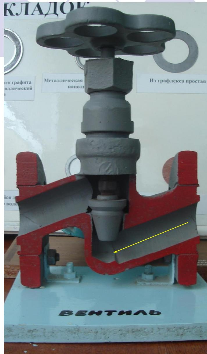
**Нормальный вентиль** имеет бочкообразный корпус 7, в котором перемещается на резьбе шпindelъ 3; к нижнему концу шпинделя крепится клапан 5. При закрывании вентиля клапан плотно прижимается к седлу 6 корпуса
