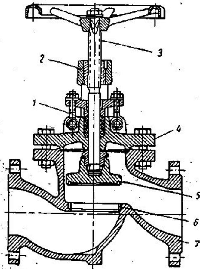
1 — сальник; 2 — ходовая гайка; 3 — шпindelъ; 4 — крышка;
