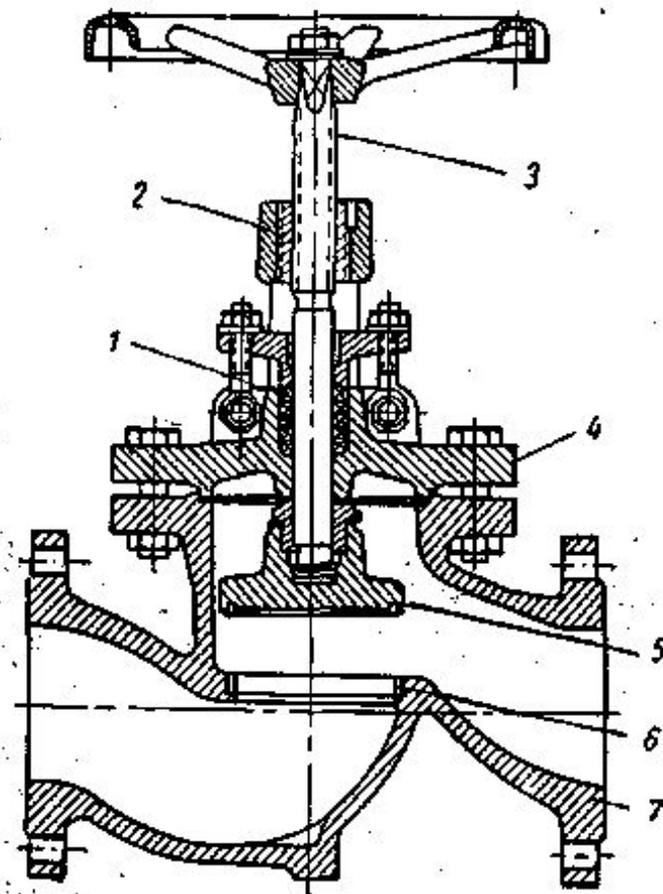
1 — сальник; 2 — ходовая гайка; 3 — шпindel; 4 — крышка;
