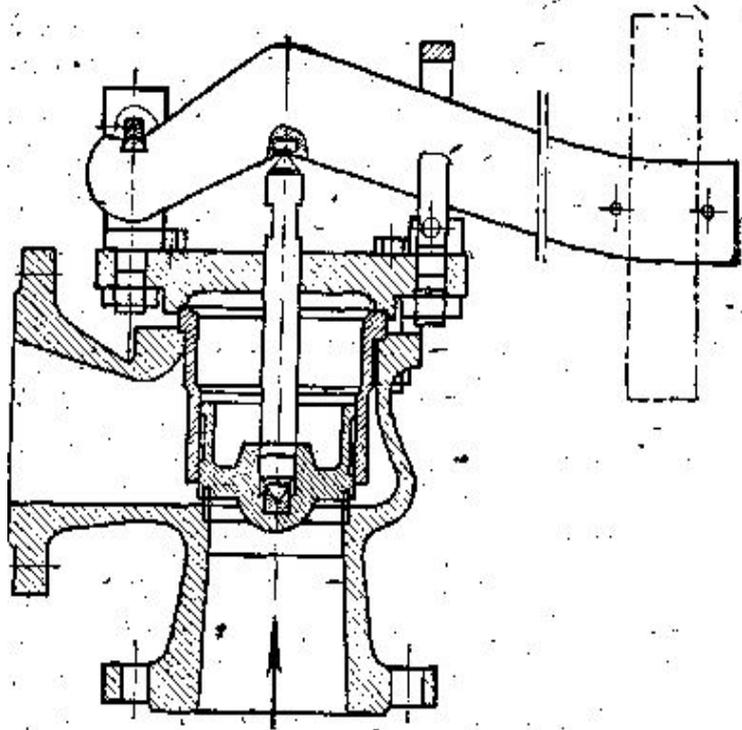
Вес грузов передаётся на золотник через рычаг и шток. Сила, действующая на золотник, регулируется путём установки большего или меньшего числа грузов. Изготавливаются из чугуна и стали. Устанавливают в котельных и компрессорных
