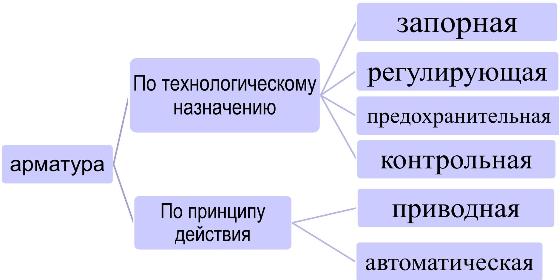
Запорная арматура предназначена для перекрытия потока рабочей среды
