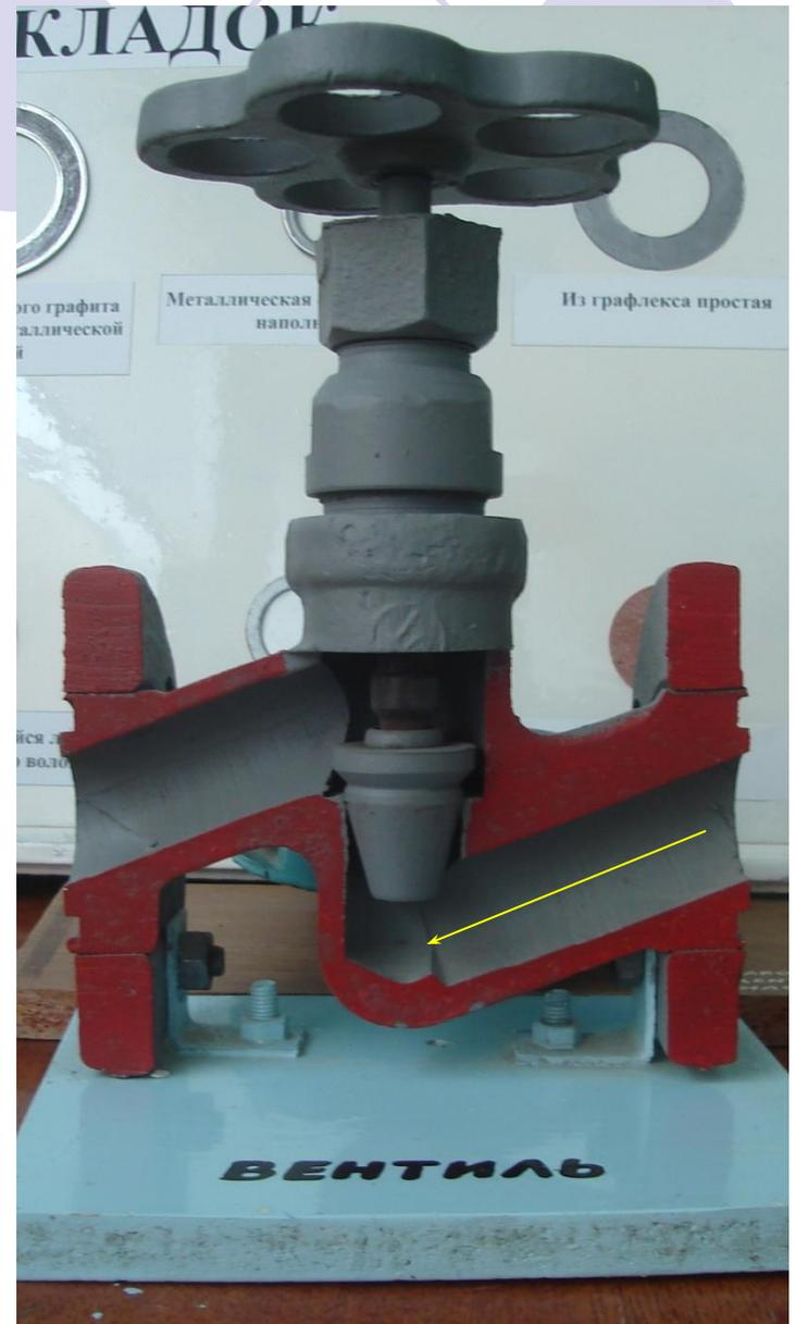
**Нормальный вентиль** имеет бочкообразный корпус 7, в котором перемещается на резьбе шпindel 3; к нижнему концу шпинделя крепится клапан 5. При закрывании вентиль клапан плотно прижимается к седлу 6 корпуса
