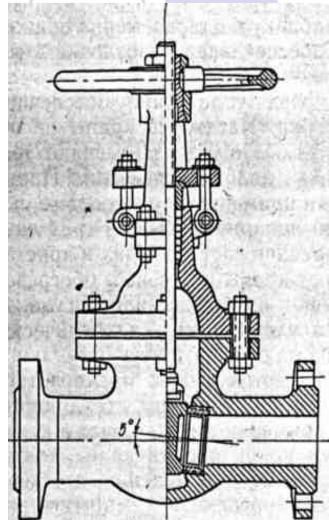
**В параллельных задвижках уплотнительные кольца расположены параллельно, а диск состоит из двух тарелок, между которыми помещается клин. При опускании диска клин распирает тарелки и прижимает их к уплотняющим кольцам.**
