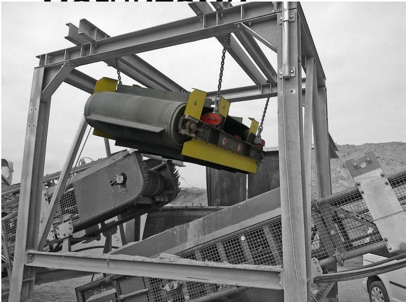
сепаратор с электромагнитом
