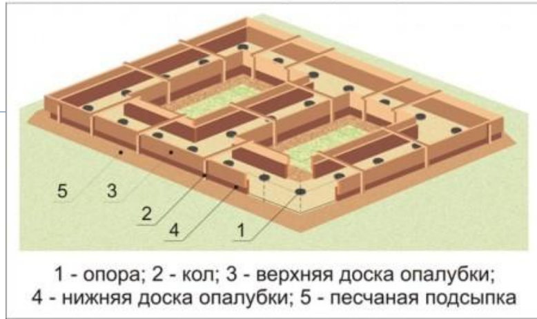
Общий вид опалубки ростверка
