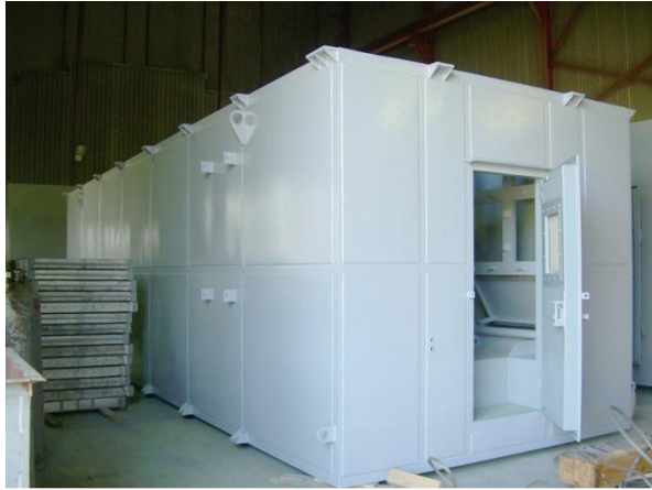
Изготовление блока воздухоочистки
