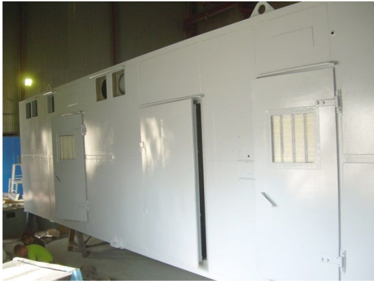
Блок маслообеспечения редуктора и генератора
