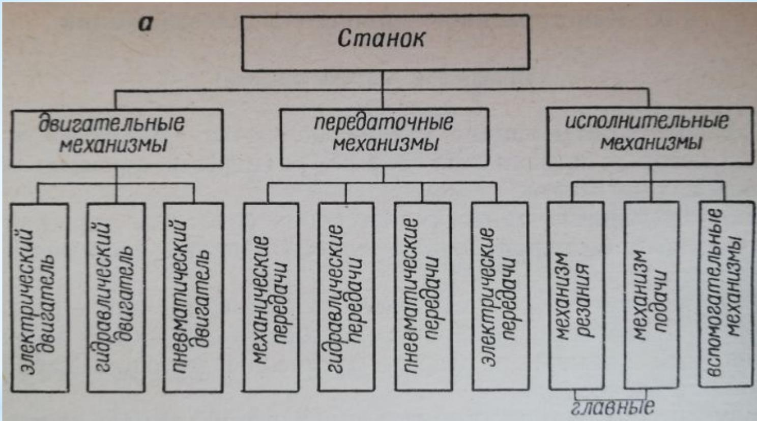
Машина — техническое устройство,
