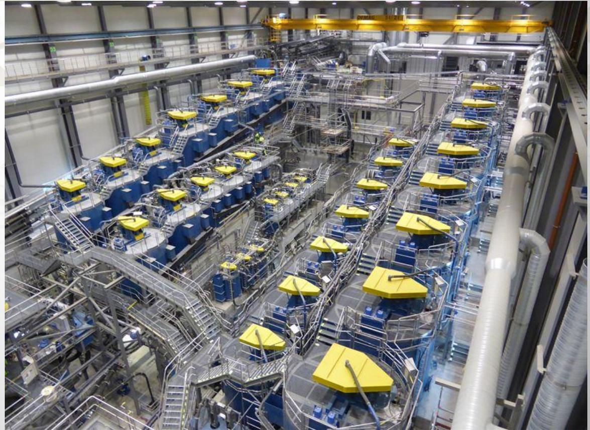
В механических флотационных машинах аэрация пульпы осуществляется засасыванием воздуха из атмосферы мешалками различных конструкций. Эти машины представляют собой аппараты, у которых насыщение пульпы воздухом и перемешивание пульпы в камере осуществляет аэратор с вращающимся импеллером, всасывая необходимый для флотации воздух непосредственно из атмосферы. Основная масса воздушных пузырьков, образующаяся при этом, имеет диаметр 0,6 – 1 мм.
