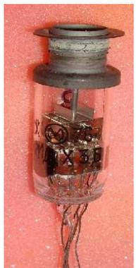
Механотроны обычно применяют для измерения больших уровней мощности и энергии импульсов лазерного излучения, например непрерывного излучения мощных СО<sub>2</sub>-лазеров и импульсного на стекле с неодимом. Современные устройства позволяют измерять мощность лазерного излучения, начиная с мощности от единиц милливатт.
