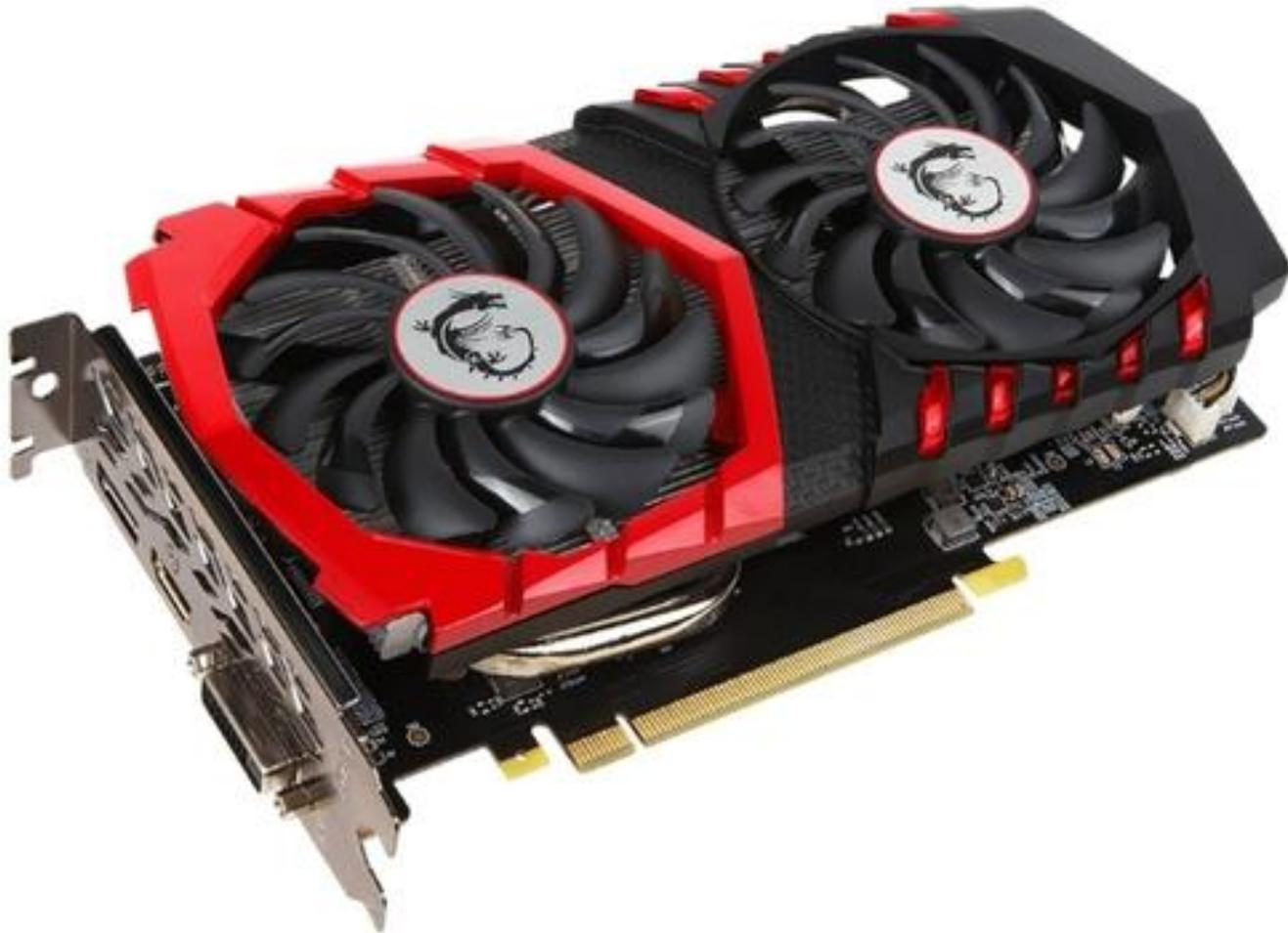
(Видеоплата, видеоадаптер, videoadapter, videocard)- устройство компьютера, которое отвечает за обработку и вывод графической информации на монитор. Видеоадаптер имеет свой собственный графический процессор, который обрабатывает 2D/3D графическую информацию. Это снижает вычислительную нагрузку на центральный процессор (CPU).
