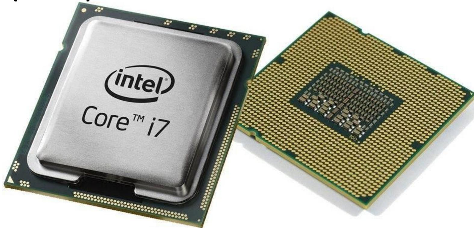
(CPU). Комплектуется охлаждающим радиатором и вентилятором (кулером). Центральный процессор – это главное устройство обработки данных. Именно он выполняет действия, из последовательности которых состоят программы. Производительность компьютера во многом зависит от быстродействия центрального процессора, которое определяется тактовой частотой работы, разрядностью, архитектурой и количеством ядер.
