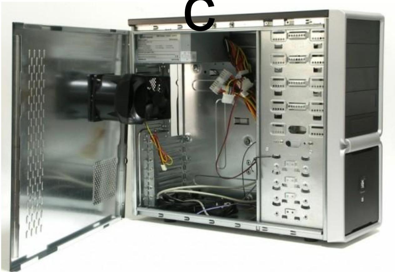
Здесь расположены все перечисленные части компьютера. Бывают различных размеров и форм-факторов. Чем корпус объемней и массивней, тем легче обеспечивать хорошее охлаждение и низкий уровень шума.
