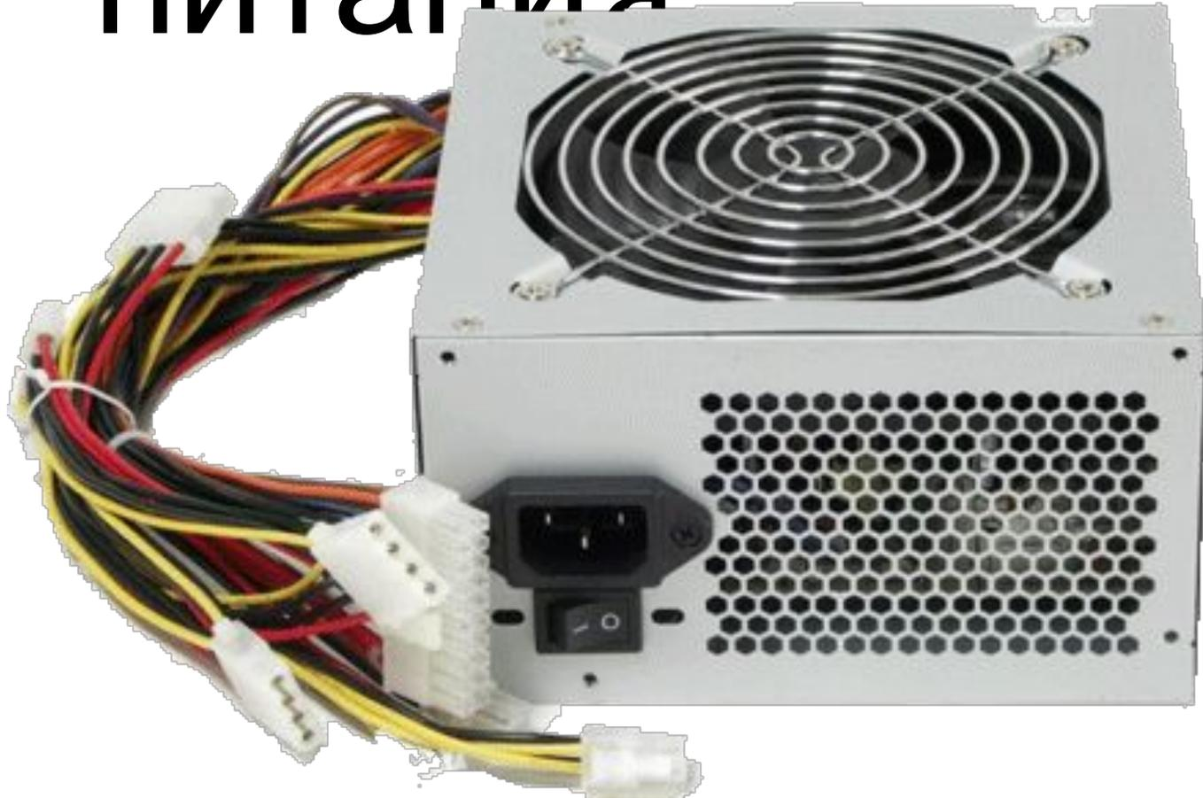
Один из важнейших компонентов, входящих в состав системного блока, так как обеспечивает питание всех частей компьютера.
