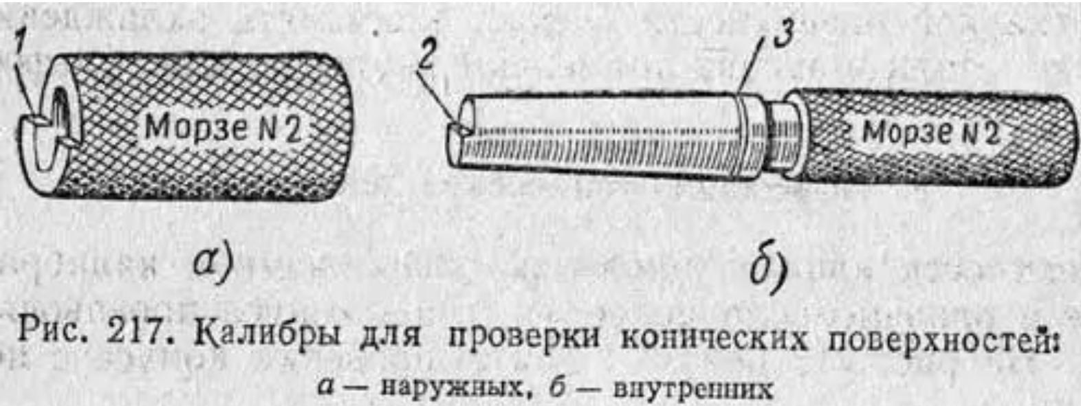
Рис. 217. Калибры для проверки конических поверхностей:
