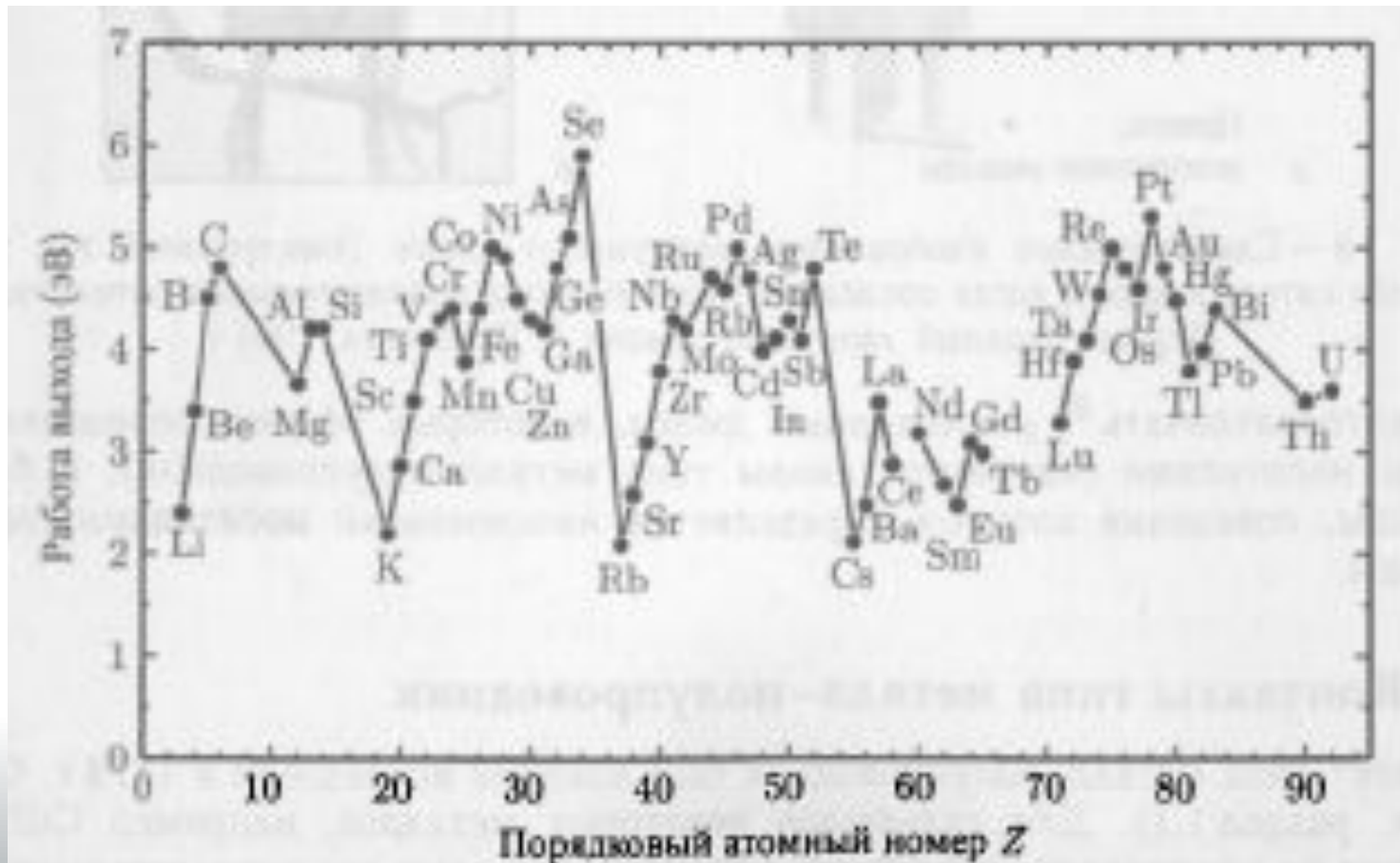
Порівняльна діаграма значень роботи виходу для різних металів
