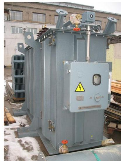
Трансформаторы с РПН обычно рассчитаны для регулирования напряжения на  $\pm 10 - 16\%$  при ступенях приблизительно в  $1,5\%$ .
