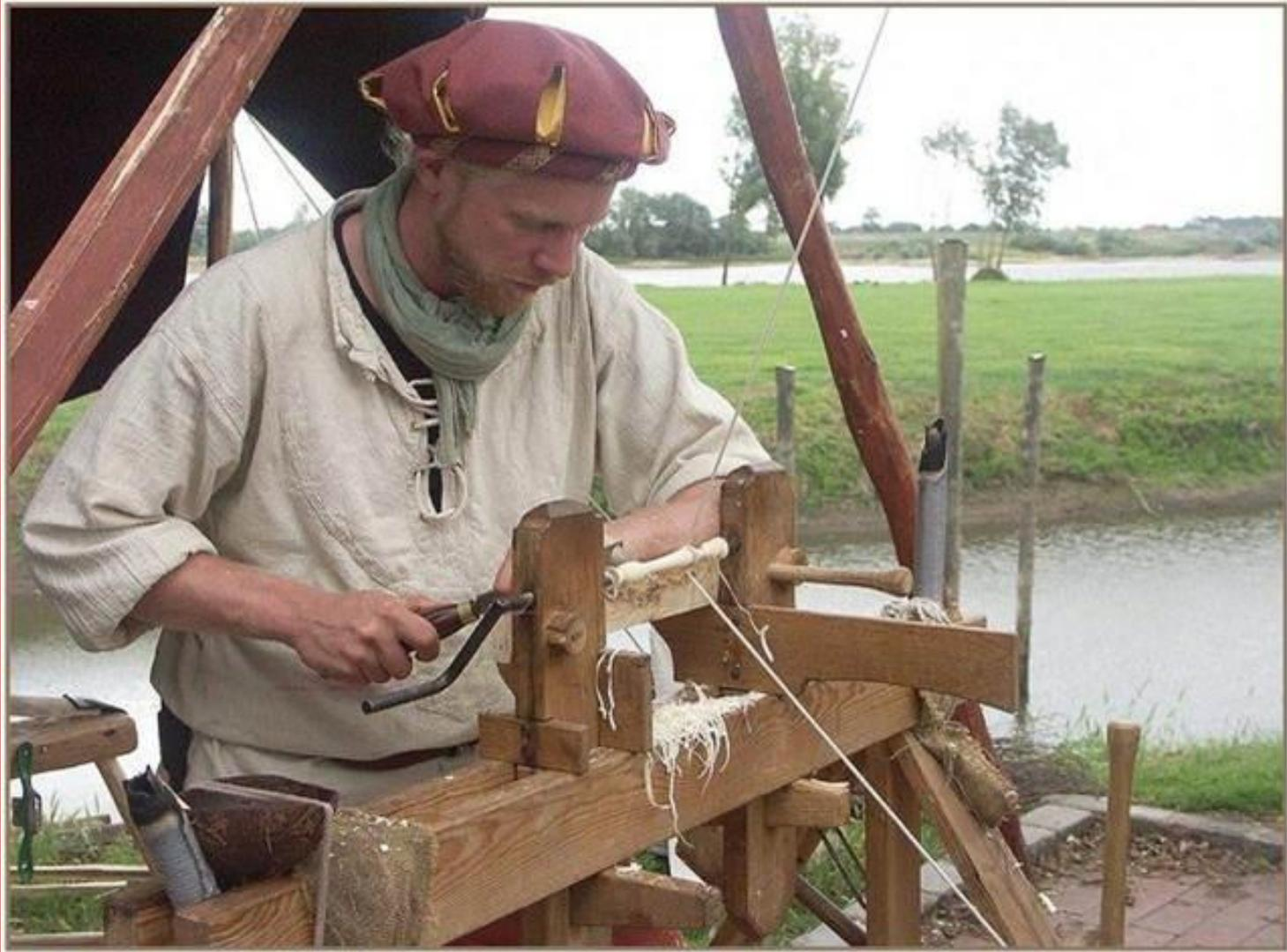
*Действующая модель средневекового токарного станка с лучковым приводом.*
