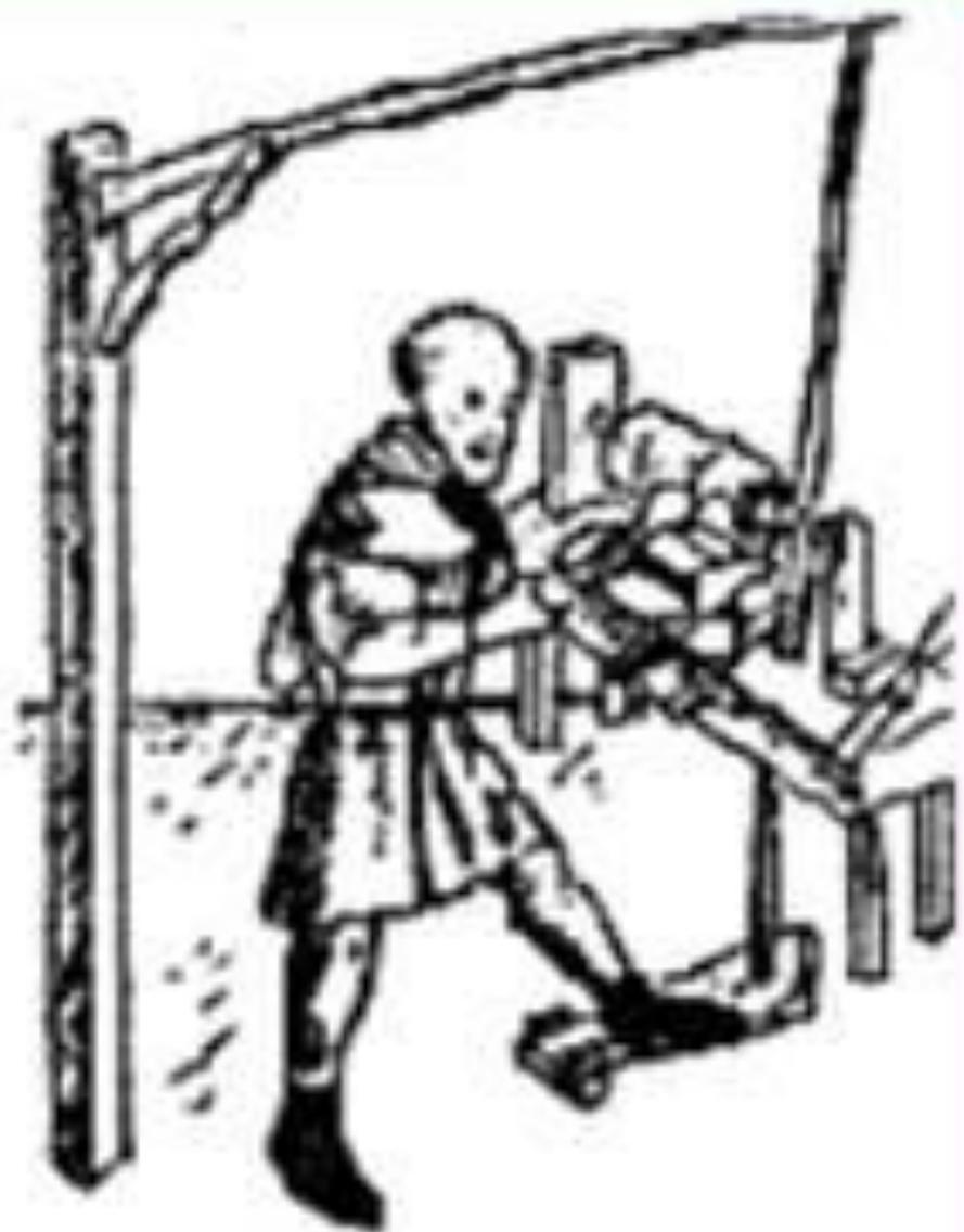
*Примерно к 1430 году вместо оцена стали применять механизм, включающий педаль, шатун и кривошип, получив, таким образом, привод, аналогичный распространённому в XX веке ножному приводу швейной машинки.*
