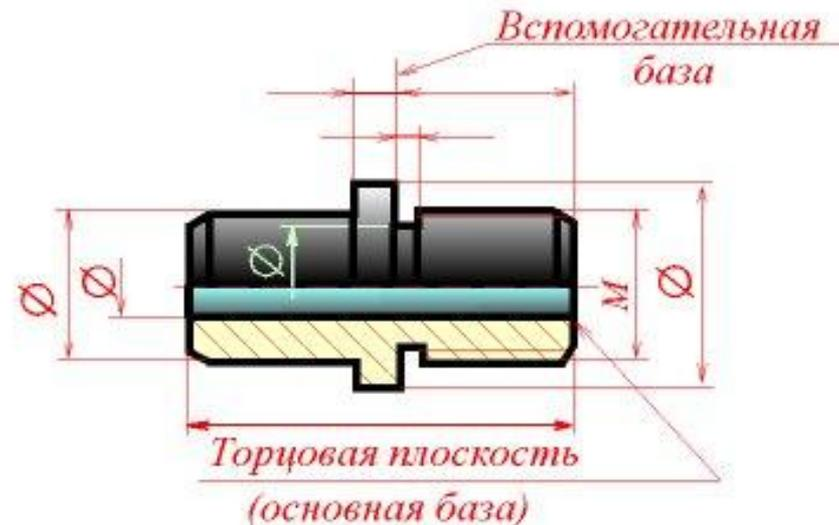
*Конструктивный элемент детали, от которого ведется отсчет размеров детали, называется базой. Это может быть поверхность или линия (осевая, центровая). В зависимости от назначения различают следующие базы: конструкторские, технологические и измерительные.*
