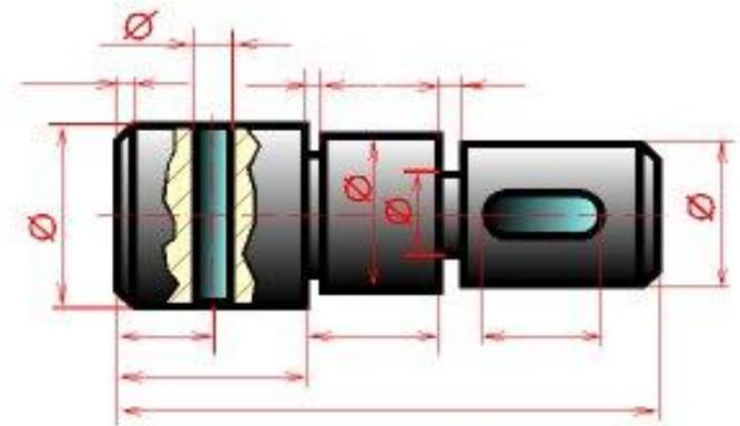
*Комбинированный метод - простановка размеров осуществляется цепным и координатным методом одновременно. Этот метод наиболее оптимален. Он позволяет изготавливать более точно те элементы детали, которые этого требуют.*
