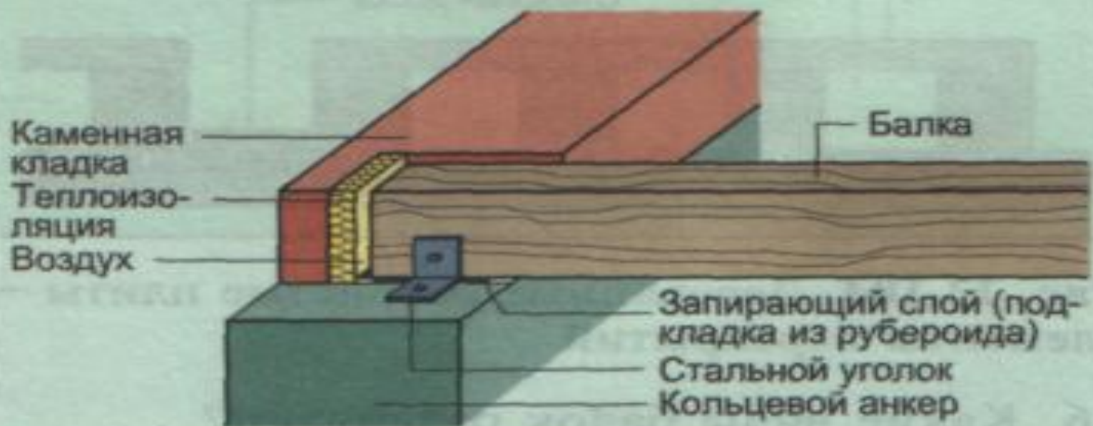
Заанкеривание на кольцевом анкере
