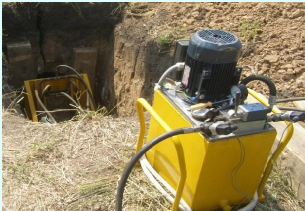
Гідравлічна станція на 16 МПа з датчиком тиску
