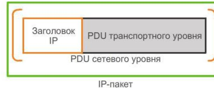
Транспортный уровень добавляет заголовок, благодаря которому пакеты могут направляться через комплексные сети и достигать места назначения. В сетях на основе TCP/IP модуль PDU сетевого уровня является IP-пакетом.
