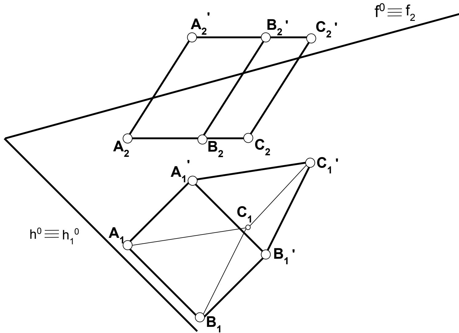
И поверхность(призма) и плоскость  $\Sigma$  - общего положения, поэтому выполняем преобразование комплексного чертежа, т.е. строим проекции вершин призмы и след плоскости  $\Sigma$  на  $\Pi_4$ :
