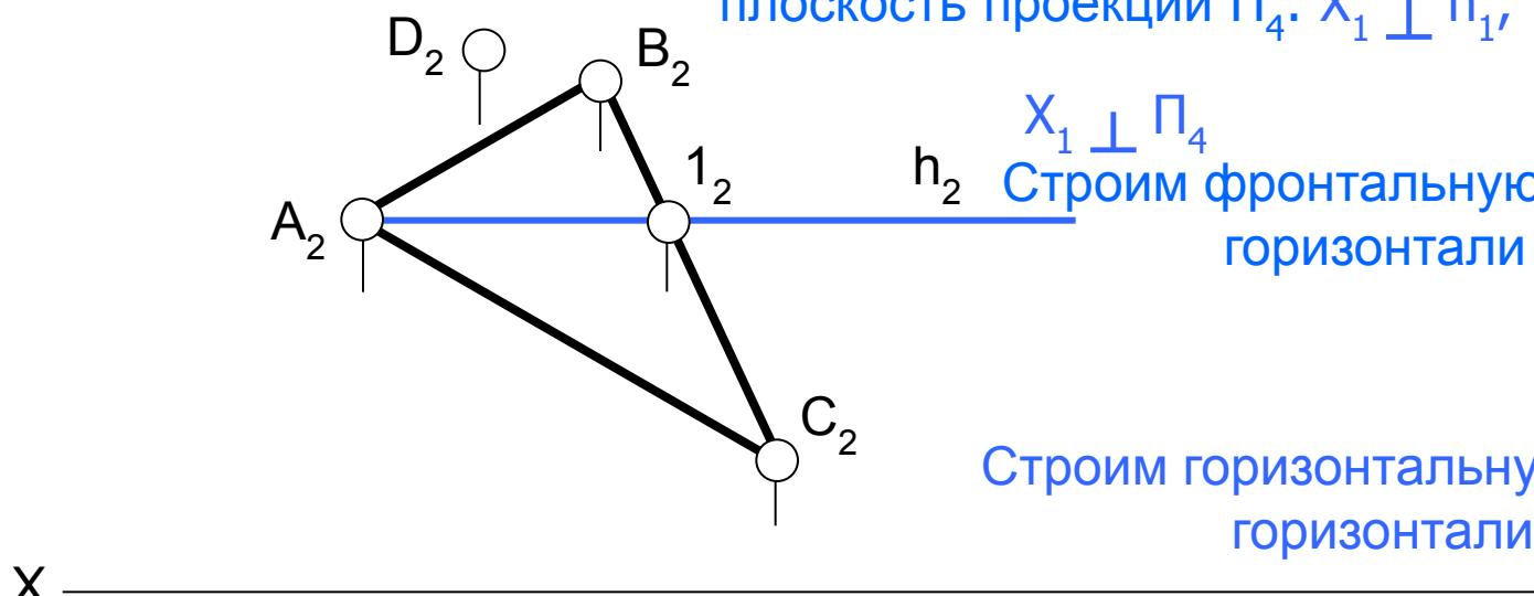
Строим горизонтальную проекцию горизонтали  $h_1$
