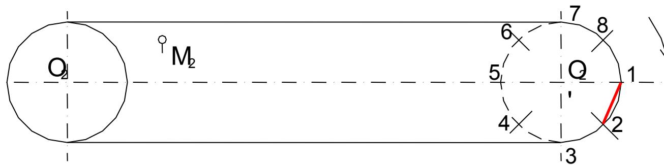
Затем из вновь полученной точки откладываем такую же хорду так, чтобы она пересекала линию 4.
