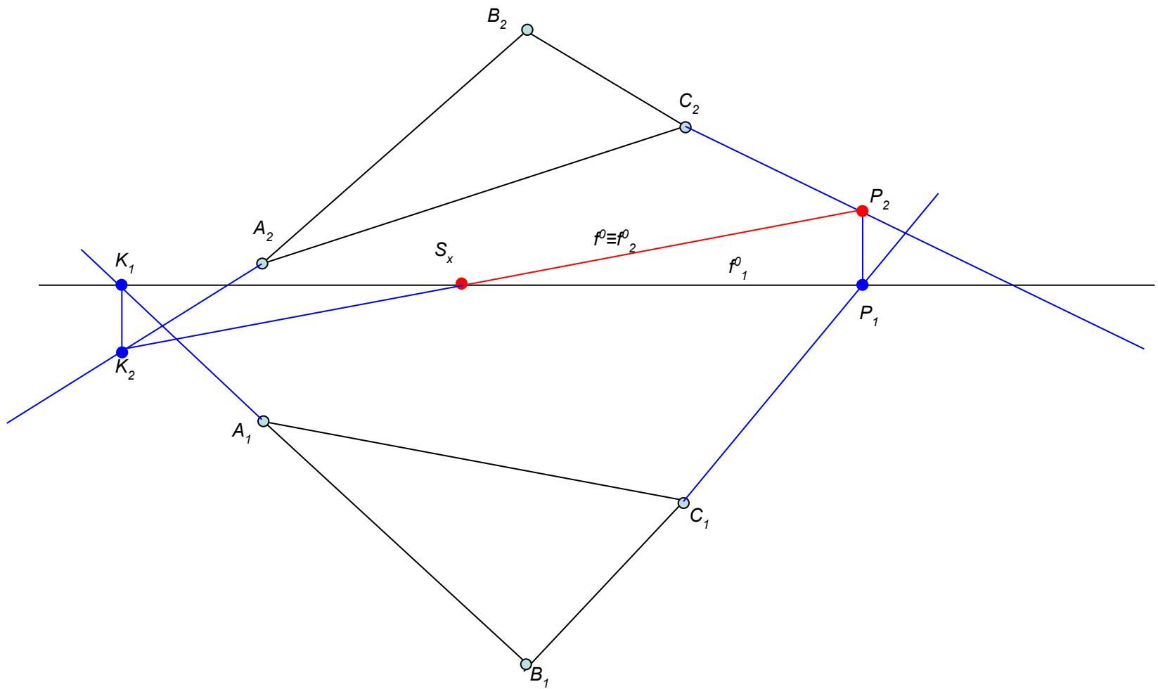
11. Построить горизонтальный след плоскости  $\Sigma$  ( $a \cap b$ ).
