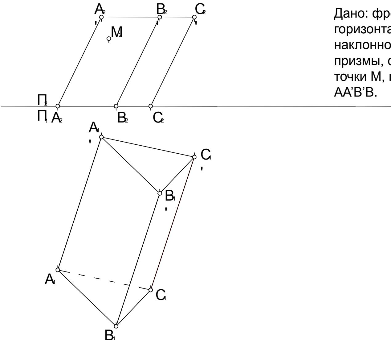
Дано: фронтальная и горизонтальная проекции наклонной призмы, фронтальная проекция точки М, принадлежащей грани AA'B'B.
