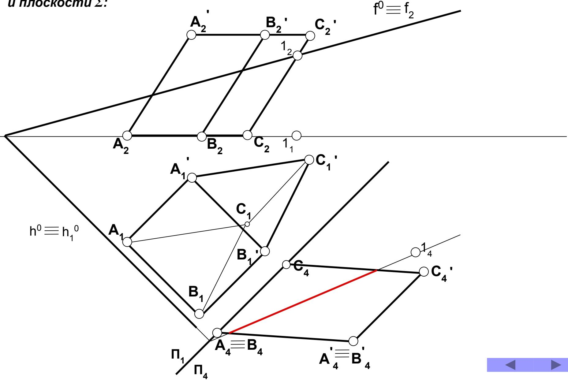
Строим проекции точек пересечения призмы и плоскости  $\Sigma$  на плоскости  $\Pi_1$  и  $\Pi_2$ :
