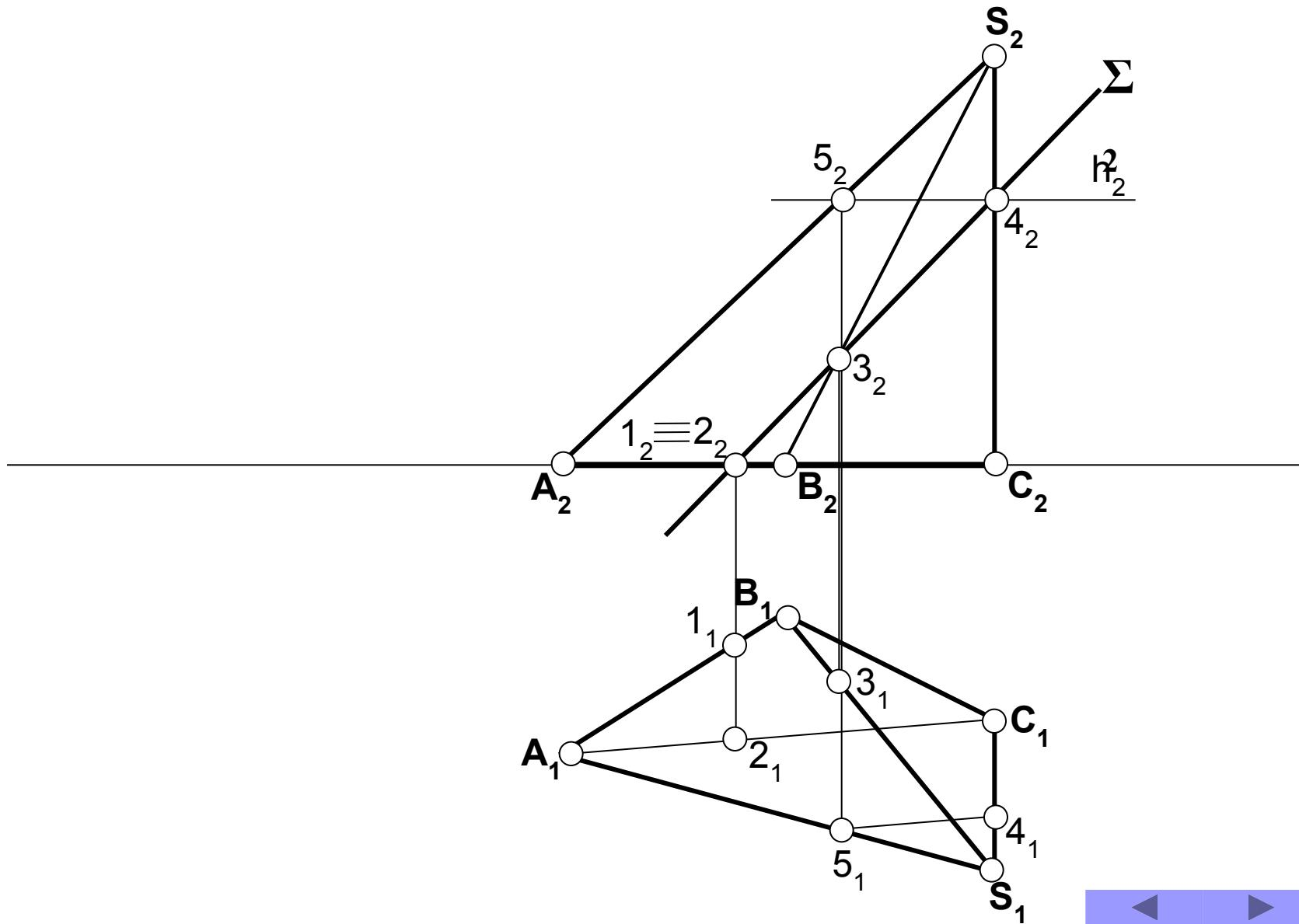
Находим проекцию сечения и определяем его видимость(если линии лежат на видимых гранях, то они также видимы; если нет, то линии невидимы):
