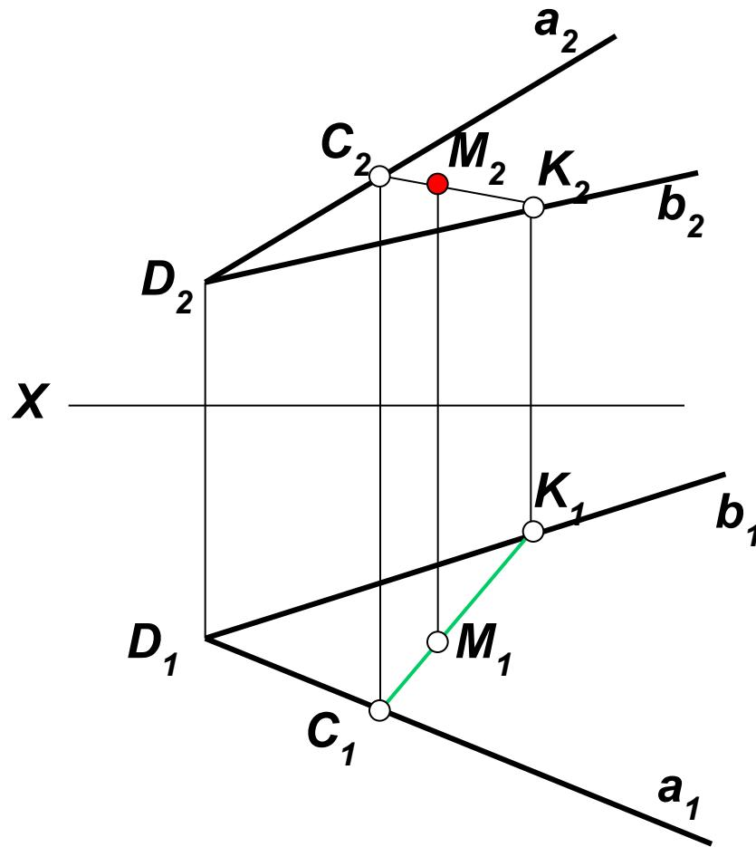
Выйдя из проекции  $M_2$  и  $K_2$  на плоскость  $a_2$ , определим проекцию точки  $M$  на плоскость  $b_2$ .
