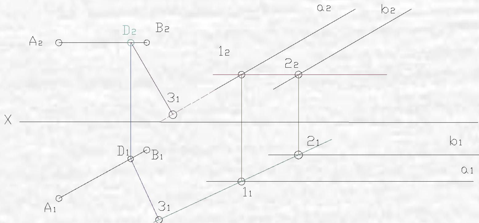
5. Из полученной точки опускаем перпендикуляр на прямую  $a_2$ , получаем плоскость перпендикулярную плоскости  $\Phi(a, b)$ .
