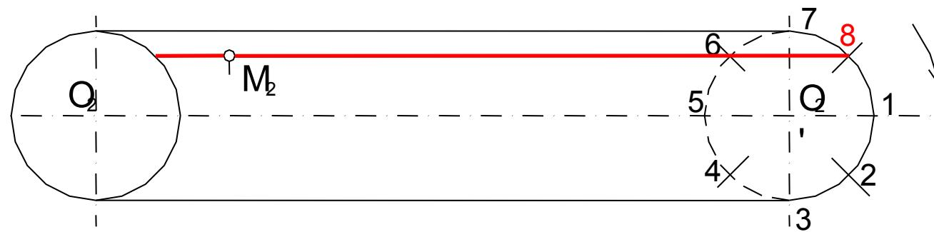
Проводим эту же образующую в горизонтальной плоскости проекций.
