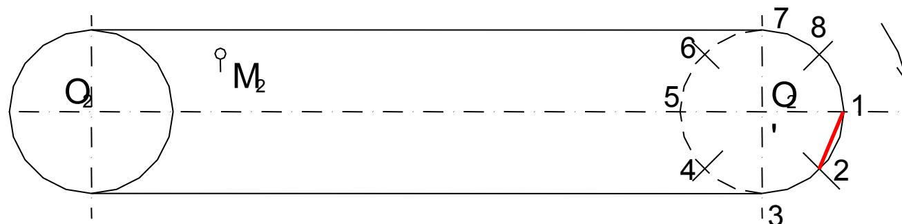
На горизонтальной плоскости проекций от точки 1 до линии 2 отложим хорду, стягивающую токи 1 и 2 на фронтальной плоскости проекций.
