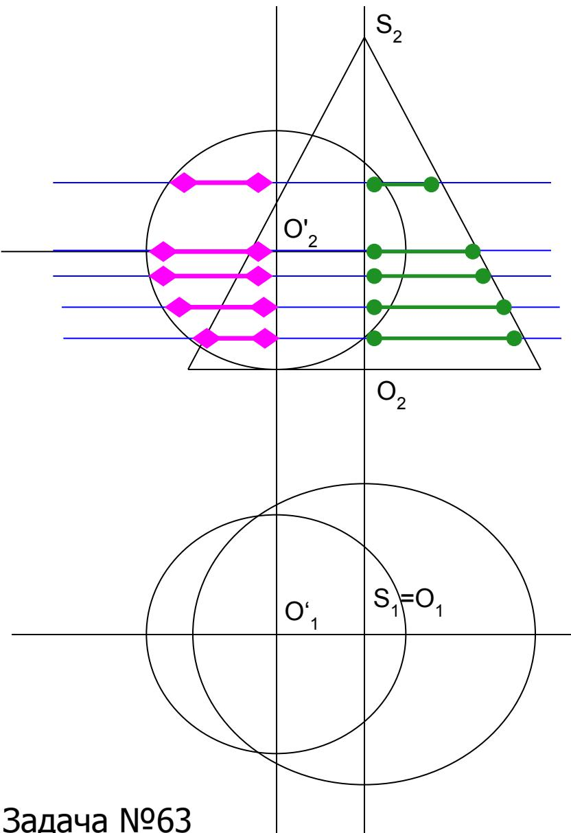
Затем на фронтальной проекции замеряю расстояния от оси цилиндра до его образующих, и этим радиусом проводим окружности на горизонтальной проекции с центром в т.  $O_1$ .
