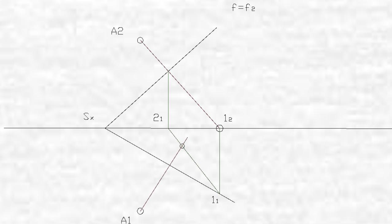
3. Опускаем перпендикуляр из точки  $A_1$  на  $h=h_1$ , продолжая его до пересечения с проекцией прямой  $A_2$   $1_2$ .
