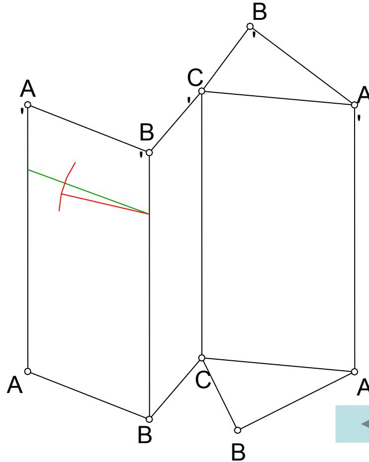
Сделаем засечку радиусом, равным отрезку горизонтали между точкой  $M_1$  и ребром  $B_1B'_1$ .
