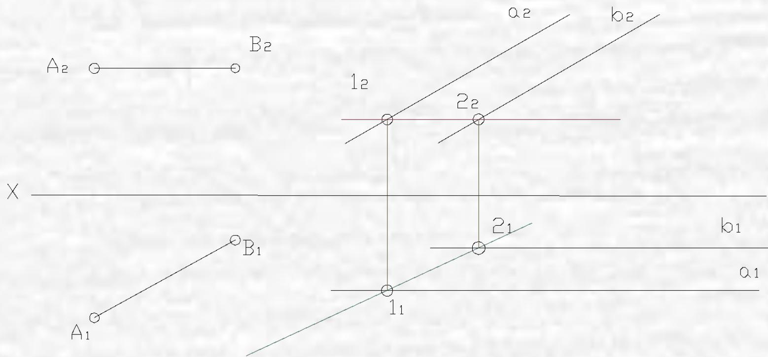
**2. Опускаем перпендикуляры из точек пересечения горизонтальной проекции с прямыми  $a_2$  и  $b_2$ . Нашли фронтальную проекцию горизонтали.**
