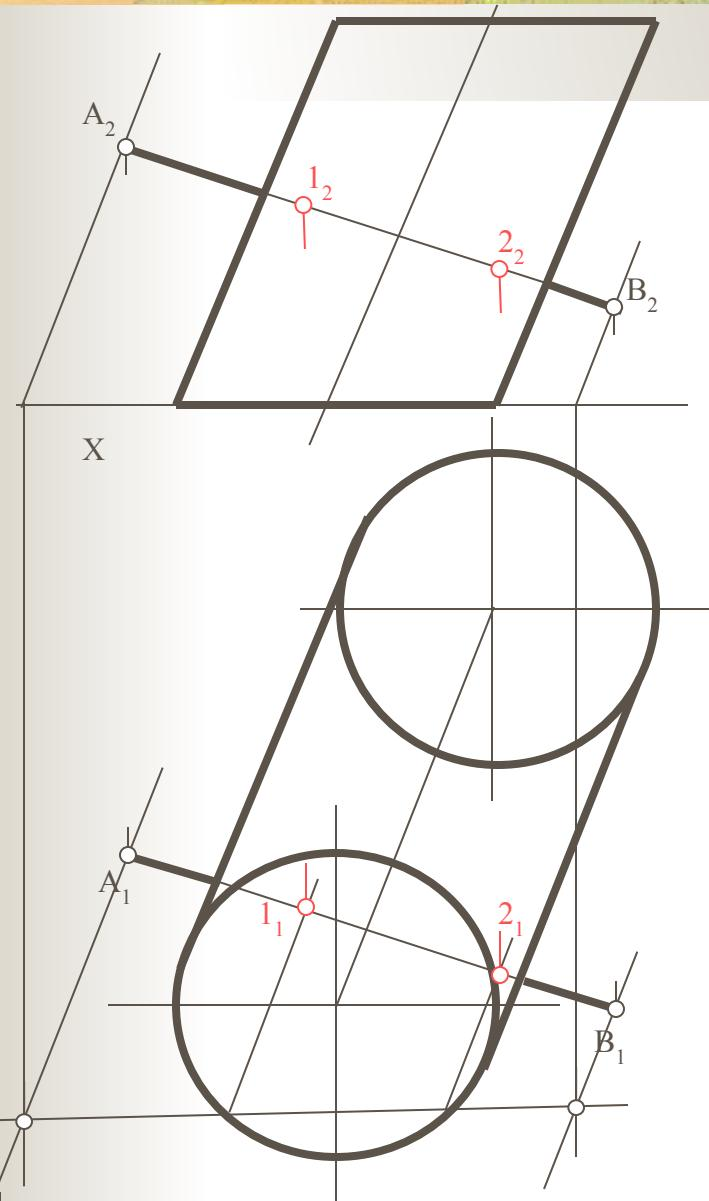
**Задание:** построить точки пересечения прямой АВ с поверхностью цилиндра. Определить видимость.
