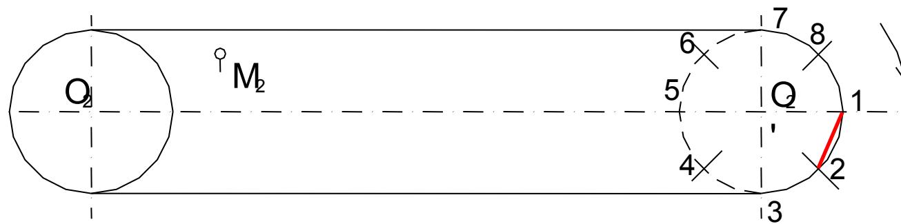
Потом из вновь полученной точки откладываем такую же хорду так, чтобы она пересекала линию 5.
