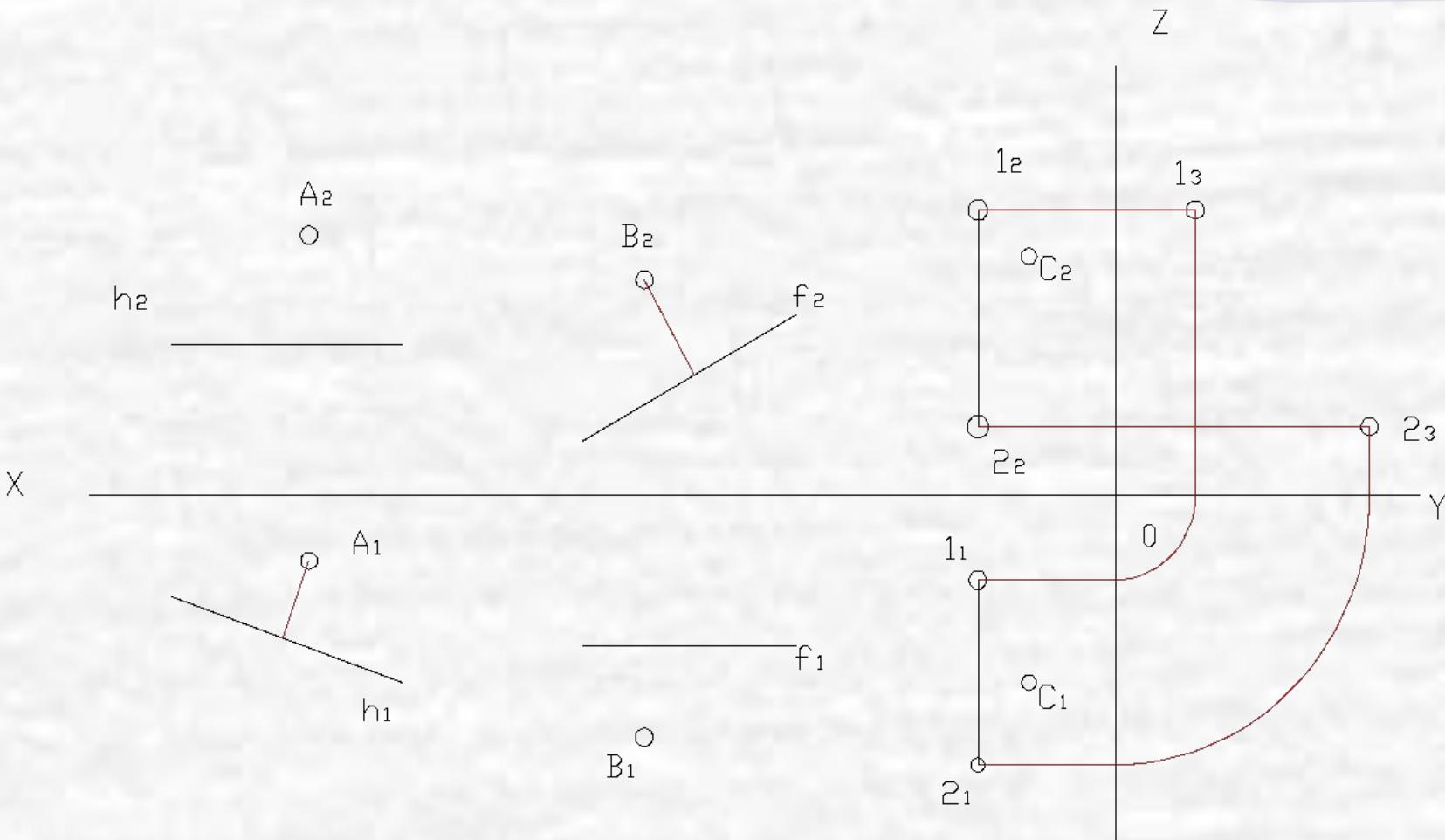
1. Проведем из горизонтальной проекции т.А горизонтальную проекцию перпендикуляра к горизонтальной проекции прямой  $h$
