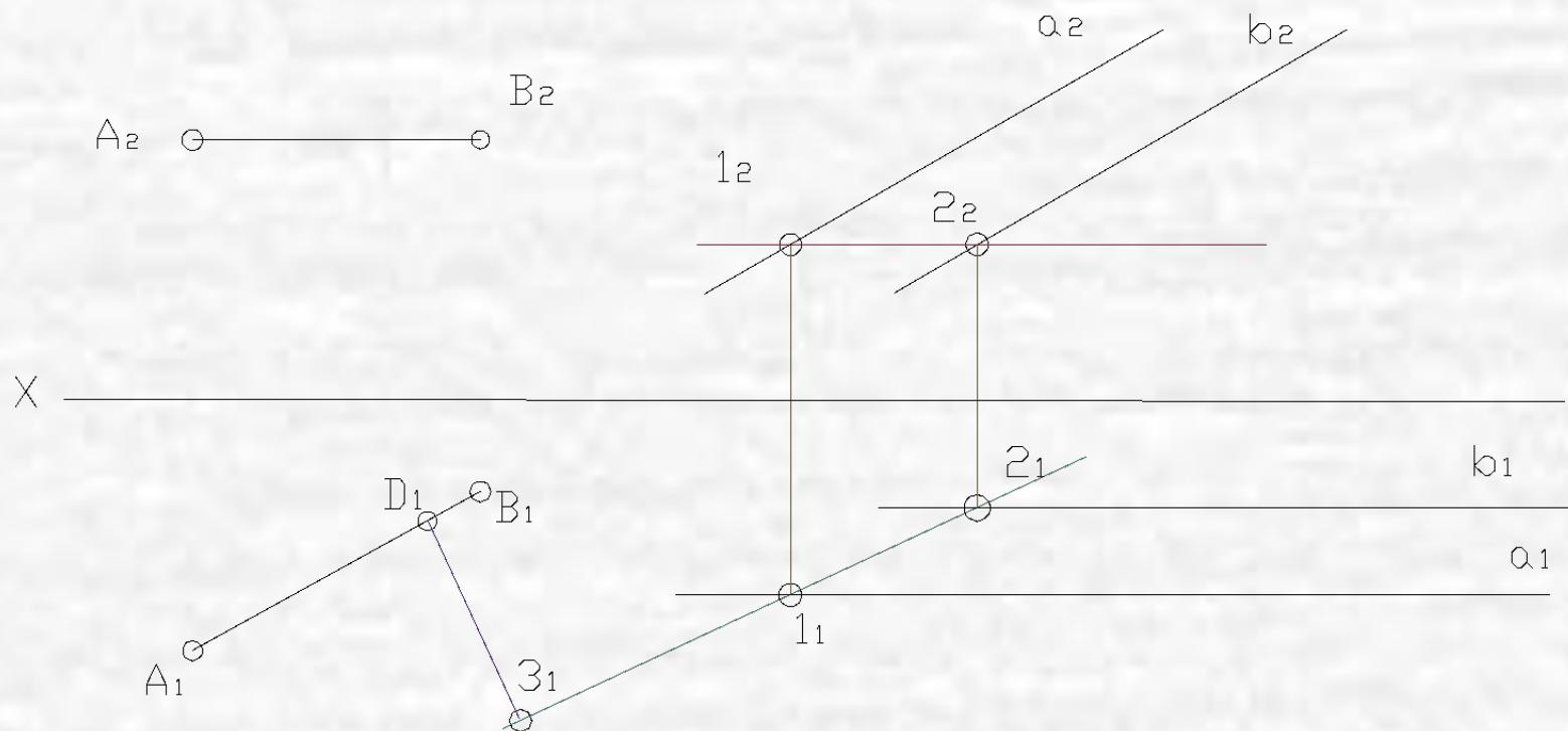
**3.Берём произвольную точку фронтальной проекции, находим проекцию на прямой  $A_1B_1$ .**
