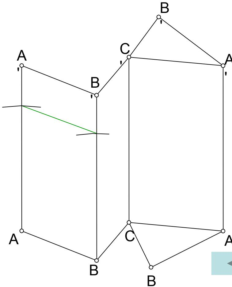
Проводим отрезок горизонтали на развертке.
