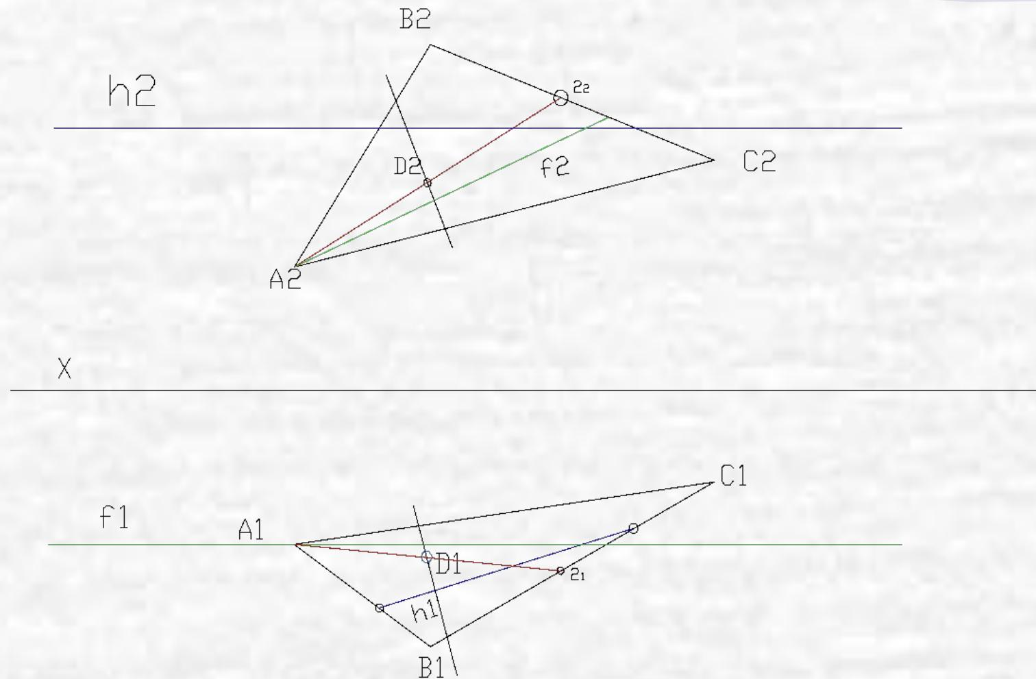
4. Опустим перпендикуляр из  $D_1$  на горизонтальную проекцию горизонтали, а из  $D_2$ -на фронтальную проекцию фронтали
