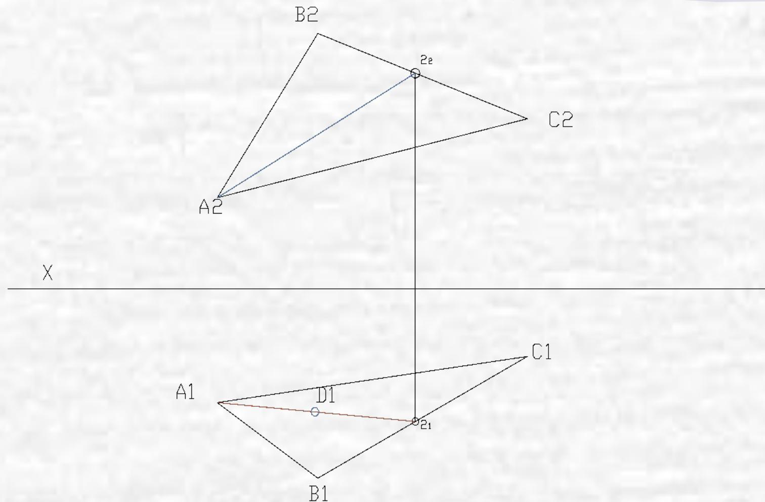
1. Проведем прямую через  $A_1$  и  $D_1$ . Точку пересечения с  $B_1C_1$  обозначим  $2_1$  и найдем фронтальную проекцию этой прямой
