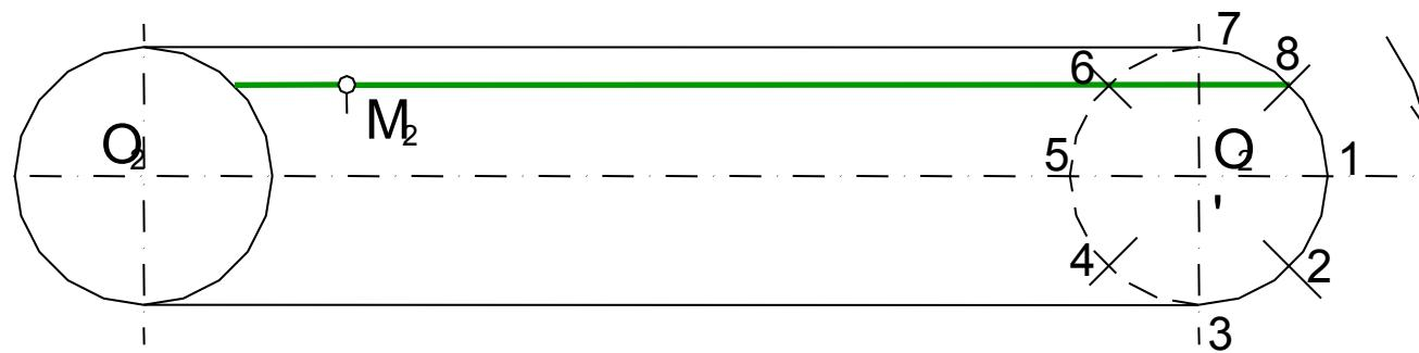
Найдем точку М на развертке. Для этого через  $M_1$  проводим прямую перпендикулярную образующей до пересечения с этой образующей на развертке.
