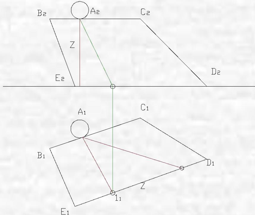
4. Откладываем на стороне  $E_1D_1$  расстояние равное  $Z$ , т.к.  $Z$ - высота на которой находится шар.
