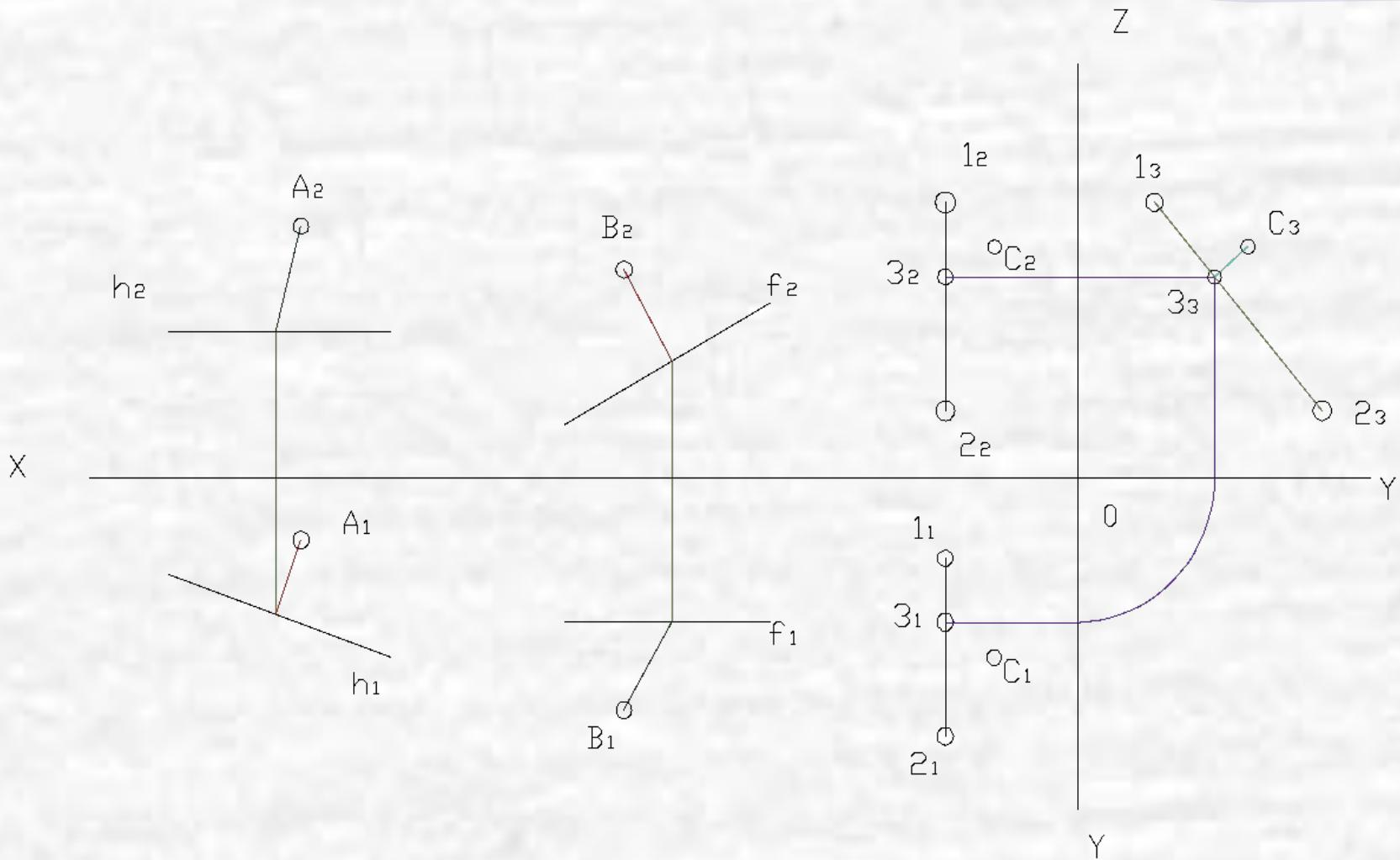
3. Найдем фронтальную и горизонтальную проекции т.З
