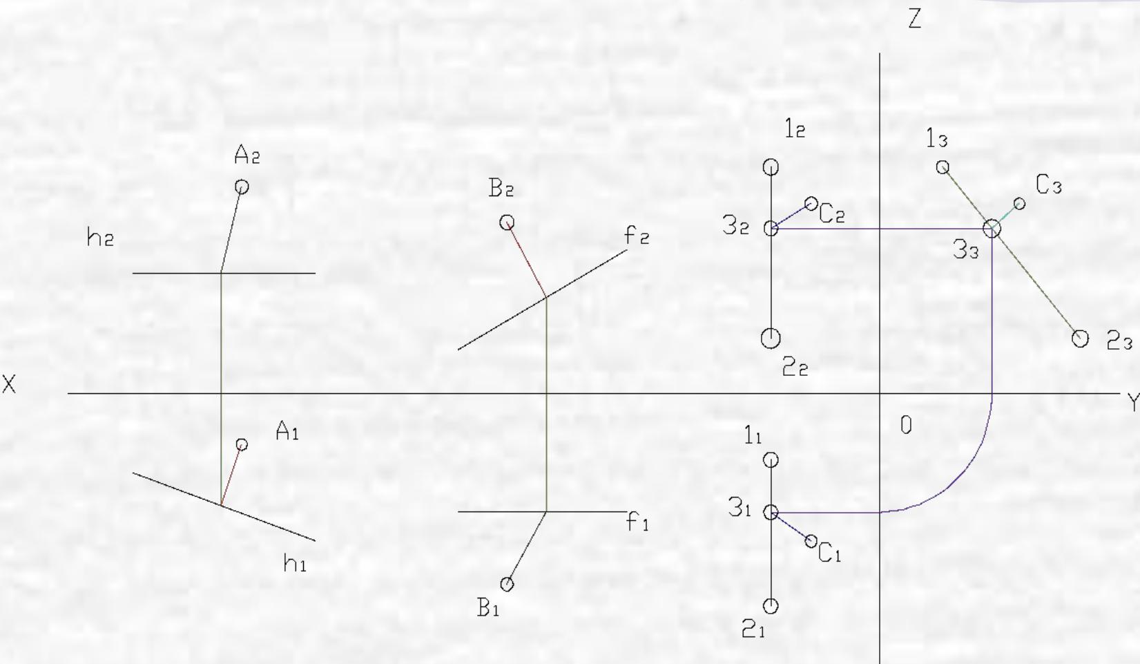
7. Соединяя получившиеся точки с точками  $C_1$  и  $C_2$ , получаем изображение перпендикуляра в плоскостях  $\Pi_1$  и  $\Pi_2$ .
