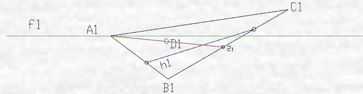
**3. Проведем горизонтальную и фронтальную проекции горизонтали и фронтали.**
