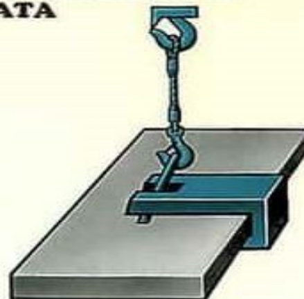
ОДИНОЧНЫЙ ГРУЗ С ИСПОЛЬЗОВАНИЕМ ЗАХВАТА
