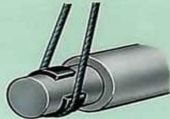
Проставка из резино- тканевых шлангов или плоских ремней
