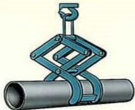
ОДИНОЧНЫЙ ГРУЗ С ИСПОЛЬЗОВАНИЕМ КЛЕЩЕВЫХ ЗАХВАТОВ
