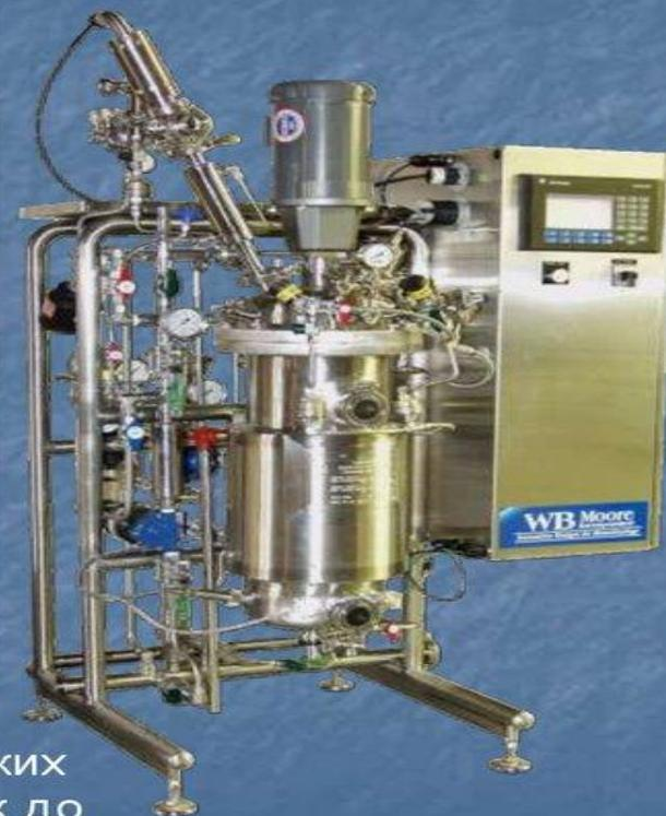
Емкость ферментера может составлять от нескольких десятков литров для экспериментальных установок до десятков тонн для промышленного производства
