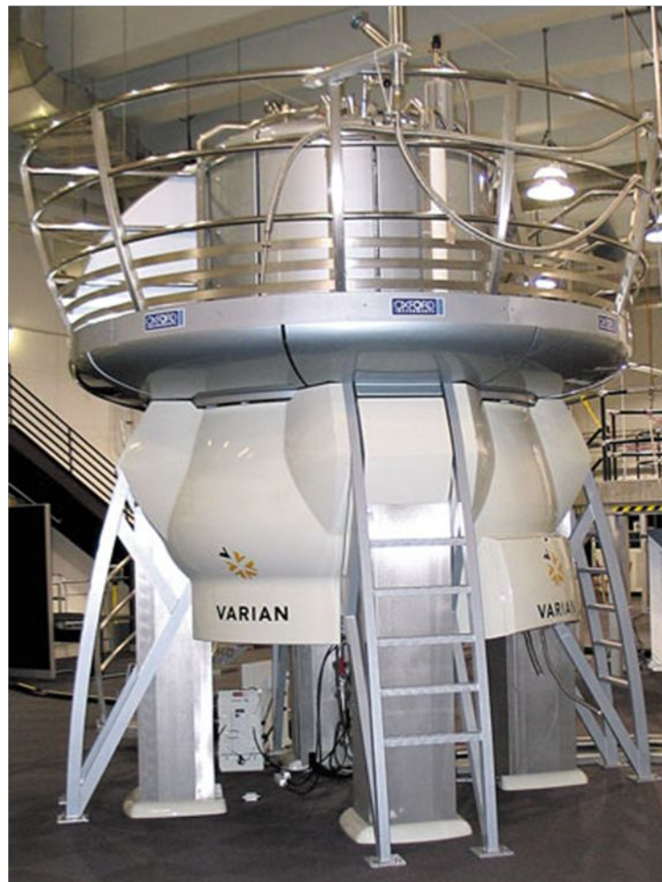
Магнит спектрометра Varian 900 МГц
