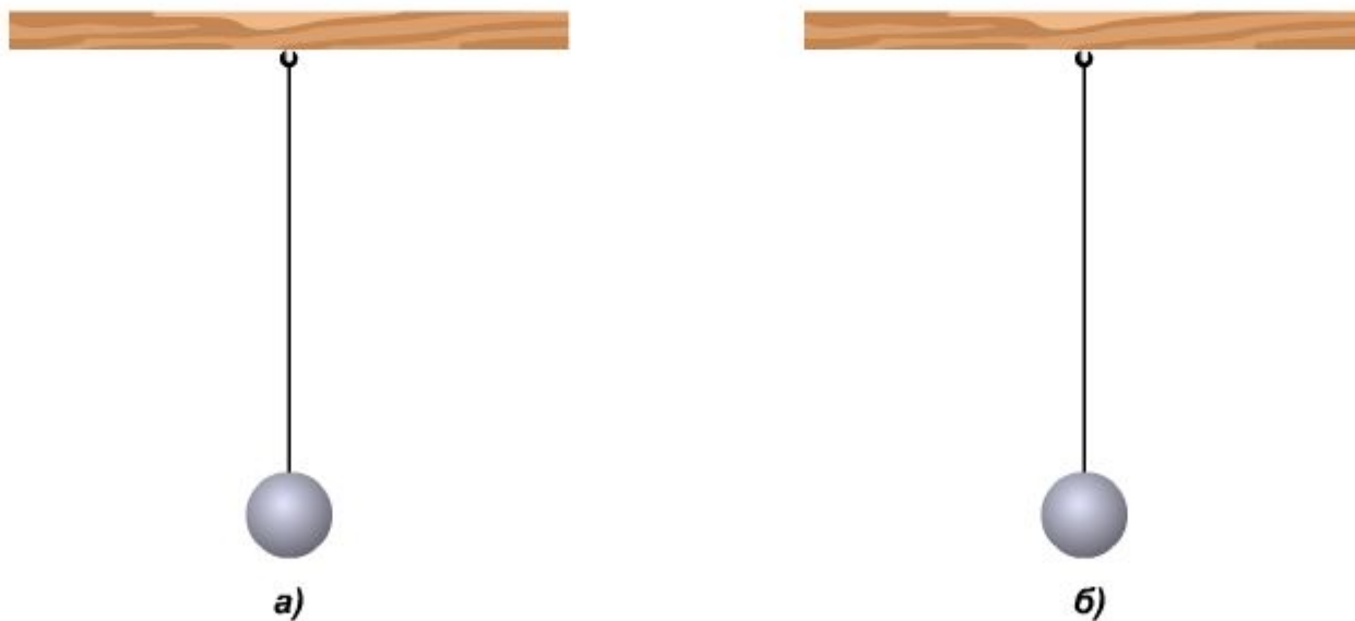
Модель 2.18. Свободные (а) и вынужденные (б) колебания
