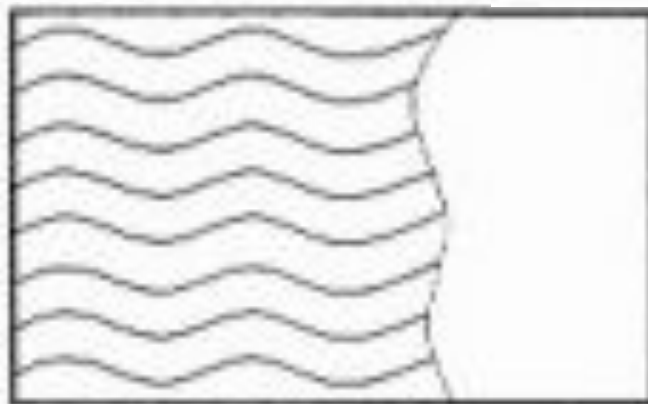
Нанесение клея зубчатым шпателем
