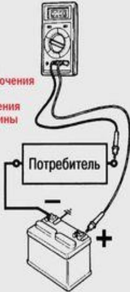
Схема подключения для измерения напряжения
