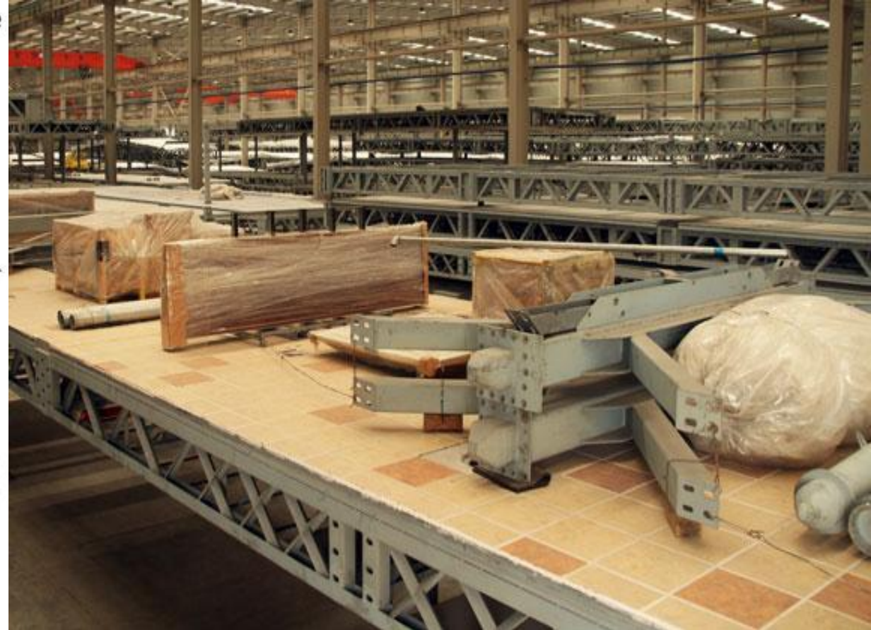
Последний этап заводского конвейера - плита перекрытия с комплектом элементов вышележащего этажа
