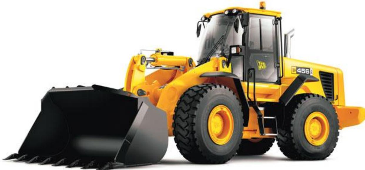
Рабочие скорости передвижения погрузчиков выбирают до 8...12 км/ч; транспортная скорость движения с неподрессоренной ходовой частью составляет 25...50 км/ч.
