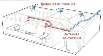
Система вытяжной вентиляции организаций, расположенных в зданиях иного назначения, оборудуется отдельно от системы вентиляции этих зданий. Шахты вытяжной вентиляции выступают над коньком крыши или поверхностью плоской кровли на высоту не менее 1 м.
