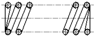
Продольный разрез пружины
