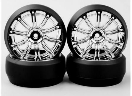
Слики обеспечивают большее сцепление с дорогой только на сухих дорогах, но имеет намного более плохое сцепление на мокрых дорогах. Из-за этого слики не подходят для использования на дорогах общего пользования, т. к. автомобили, эксплуатируемые на таких дорогах, должны быть готовы ко всем погодным условиям. Они находят применение в автомобильных соревнованиях, где участники могут подобрать себе тип шин для заезда в соответствии с погодой (а также сменить их непосредственно во время соревнования).
