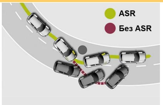
3) Электронный контроль устойчивости (Система курсовой устойчивости) – это активная система безопасности, которая позволяет предотвратить занос автомобиля посредством управления компьютером момента силы колеса (одновременно одного или нескольких).
