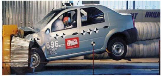
Мы проводим только фронтальный краш-тест. Статистика аварий показывает, что удары со смещением или под углом между двумя автомобилями наиболее распространены по сравнению с другими типами столкновений.
