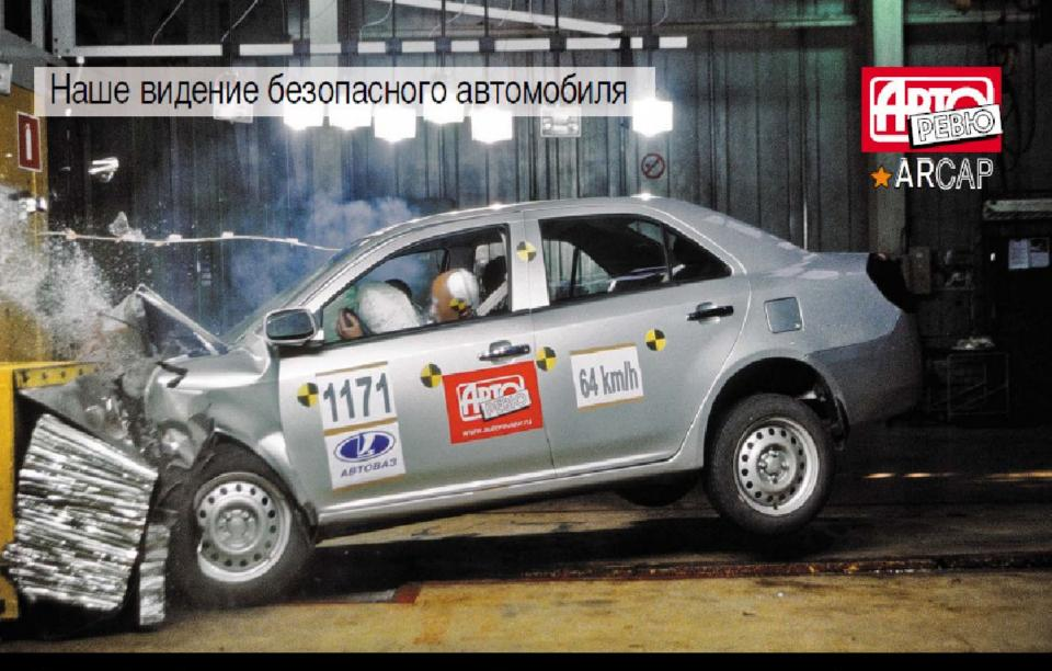
Интерьер обязан быть травмобезопасным, а кузов должен быть рассчитан на столкновения на высокой скорости: иметь жесткую клетку салона и эффективные энергопоглощающие зоны. Но и это не обеспечит должной защиты без четко работающих удерживающих систем — подушек и ремней. На примере автомобиля Geely МК мы в этом убедились.
