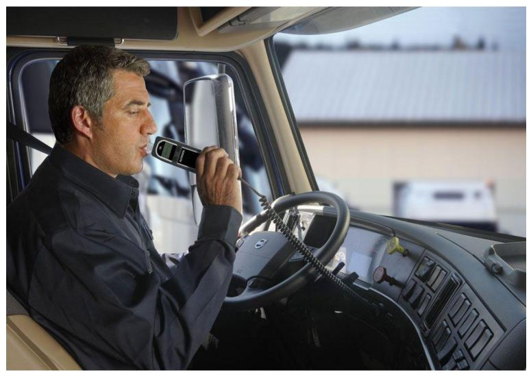
Суть алкозамка заключается в недопущении водителя, в крови которого имеется алкоголь, к управлению транспортным средством. Устройство фиксируется перед водителем, а подключается к цепи зажигания.
