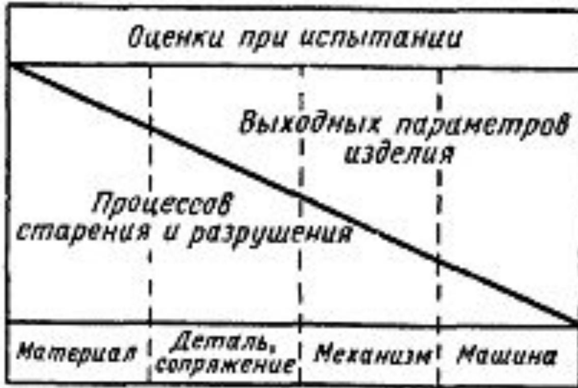
**Измерение характеристик объекта при испытании на надежность в зависимости от его сложности**
