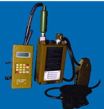
Носимая ЧМ радиостанция предназначена для ведения открытой или технически защищенной симплексной радиосвязи на любой из 8-и заранее подготовленных частот.
