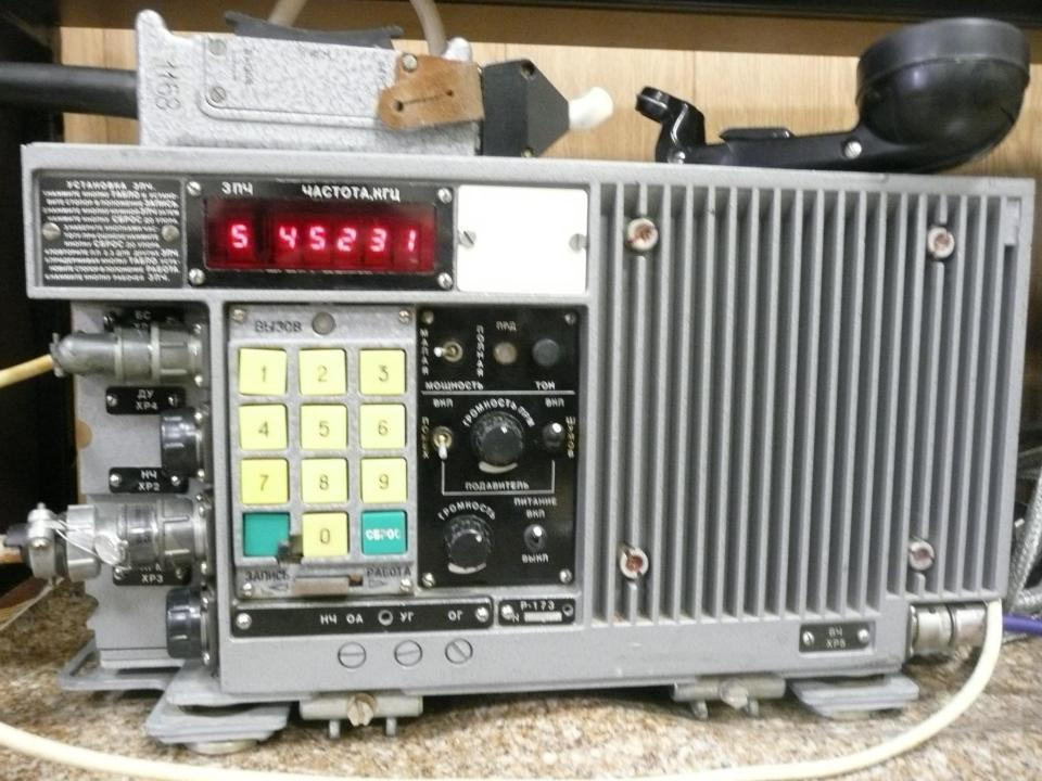
**Частотный диапазон** - от 30 до 74,999 МГц, шаг сетки - 1 кГц, имеется 45000 рабочих частот.
