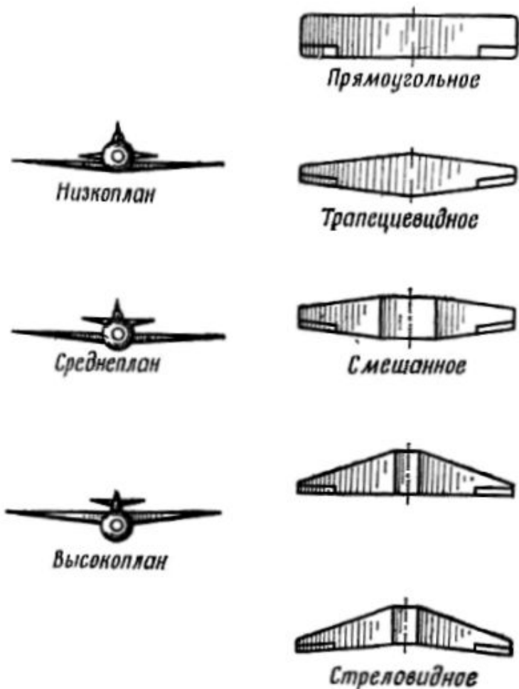
Рис. 1.15. Основные схемы расположения крыла и их формы
