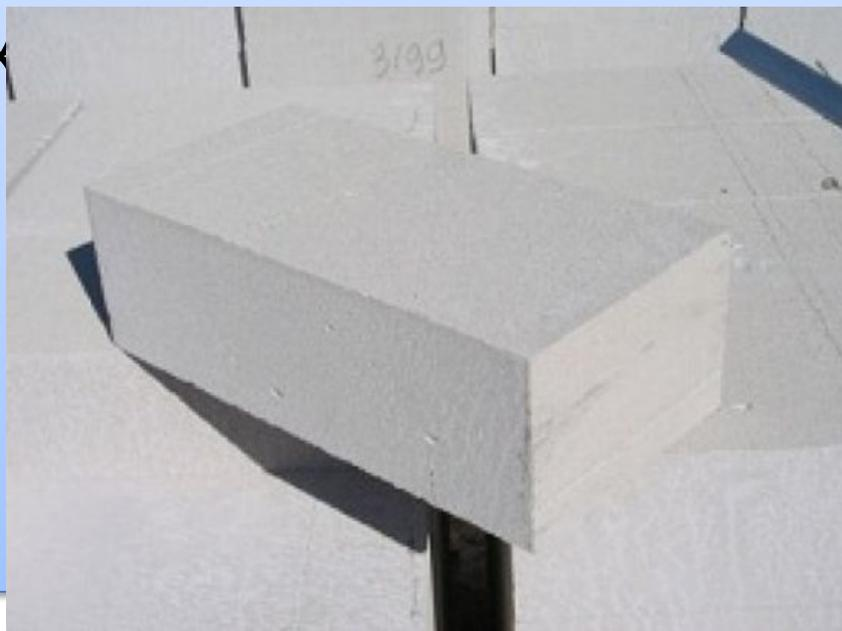
Они эффективно твердеют только в среде нагретого насыщенного пара в автоклавах, где температура  $175^{\circ}\text{C}$  и более и давление 0,9.
