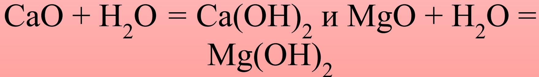
При этом 1 кг извести-кипелки выделяет 1160 кДж теплоты, которая переводит часть воды в парообразное состояние.
