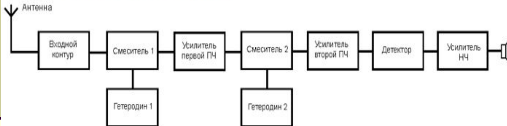
Блок-схема супергетеродинного приемника с двойным преобразованием частоты.
