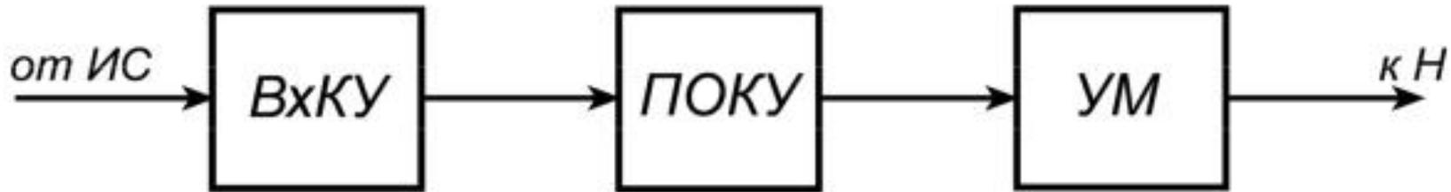
Структурная схема многокаскадного усилителя:
