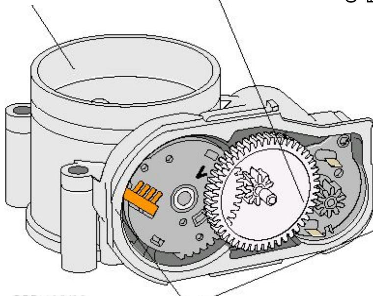
Датчики угла открытия привода дроссельной заслонки G 187 и G 188
