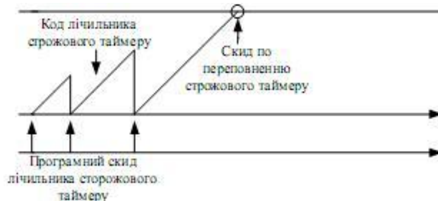
Принцип дії сторожового таймеру показаний на рис.
