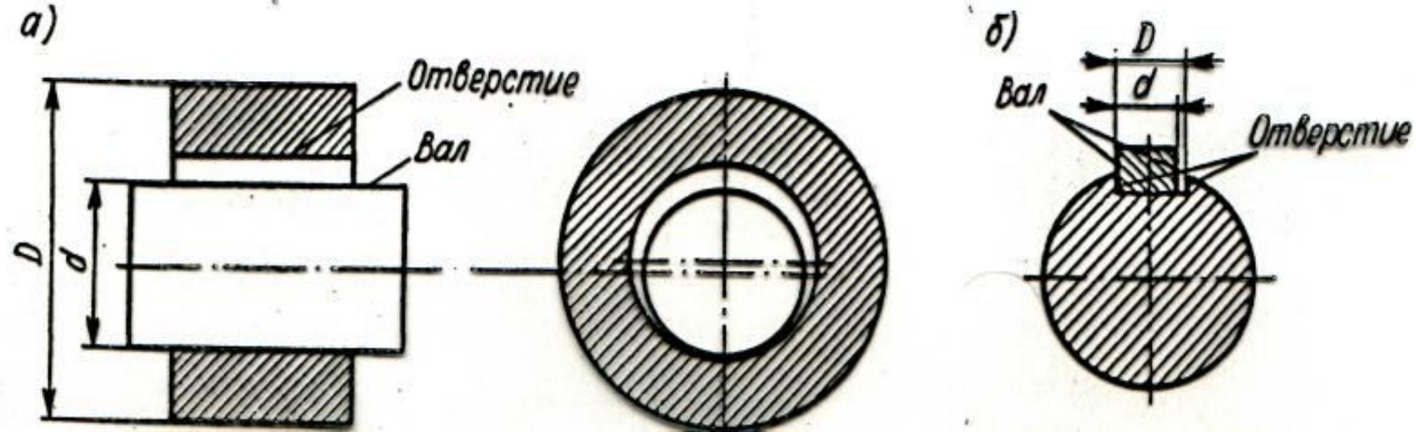
**Вал** – термин, условно применяемый для обозначения наружных охватываемых поверхностей.
