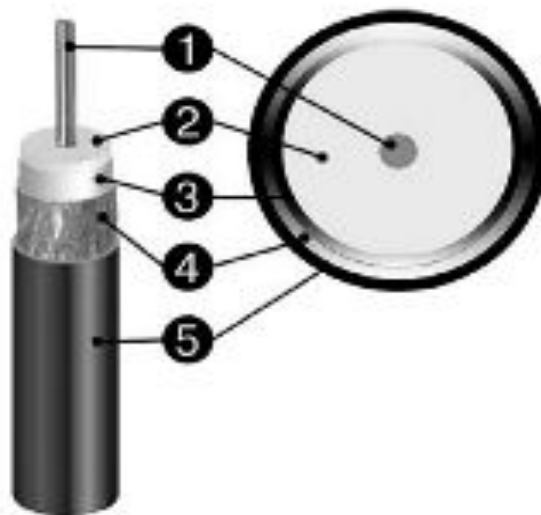
Рис. 2.2. Коаксиальный кабель: 1 – центральный проводник CCS; 2 – диэлектрическая прослойка из полиуретана; 3 – экран из алюминиевой фольги; 4 – экран из алюминиевой проволоки; 5 – оболочка из УФ-стабилизированного ПВХ
