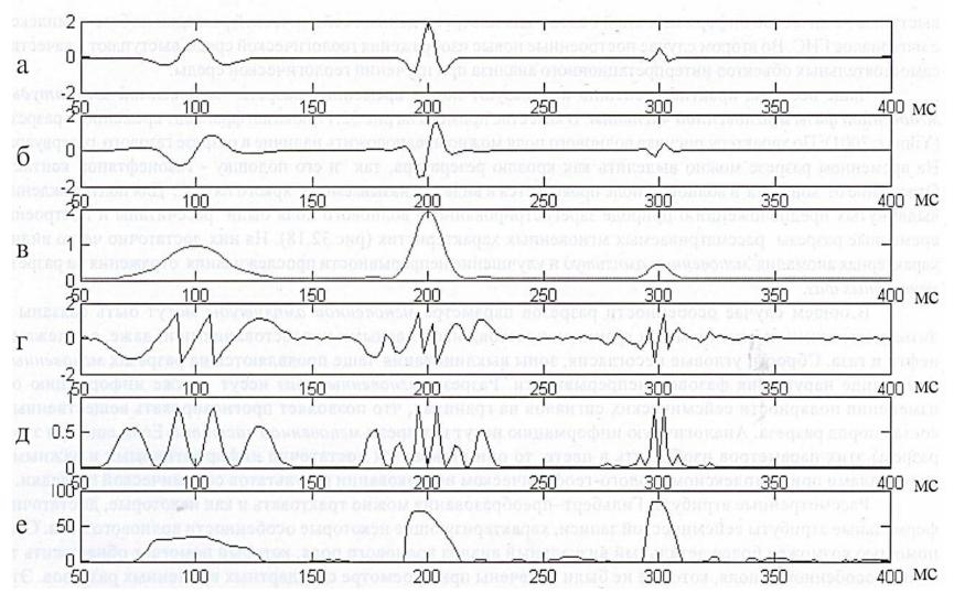
Действительная (а) и сопряженная (б) сейсмические трассы, соответствующие теоретической сейсмограмме, а также трасса мгновенных амплитуд (в), трасса мгновенных фаз (г), трасса косинусов мгновенных фаз (д) и трасса мгновенных частот (е). В качестве модельной сейсмической трассы принята трасса, состоящая из трех импульсов
