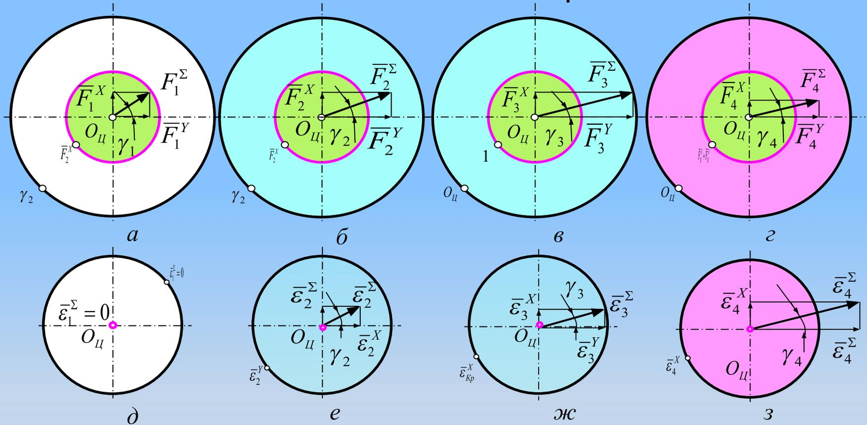
Окружности: – ( $O_{ц1}$ ) геометрическое место предельных значений результирующих векторов сил трения – трения «покоя» ( $\bar{F}_{п. max}$ ); ( $O_{ц2}$ ) – геометрическое место предельных значений суммы результирующих векторов сил трения "покоя" и "крипа" ( $\bar{F}_{п. max} + \bar{F}_{к. max}$ ); ( $O_{ц3}$ ) – геометрическое место критических значений результирующих векторов абсолютной скорости скольжения ( $\bar{\epsilon}_{кр}^{\Sigma}$ ) колеса по рельсу.
