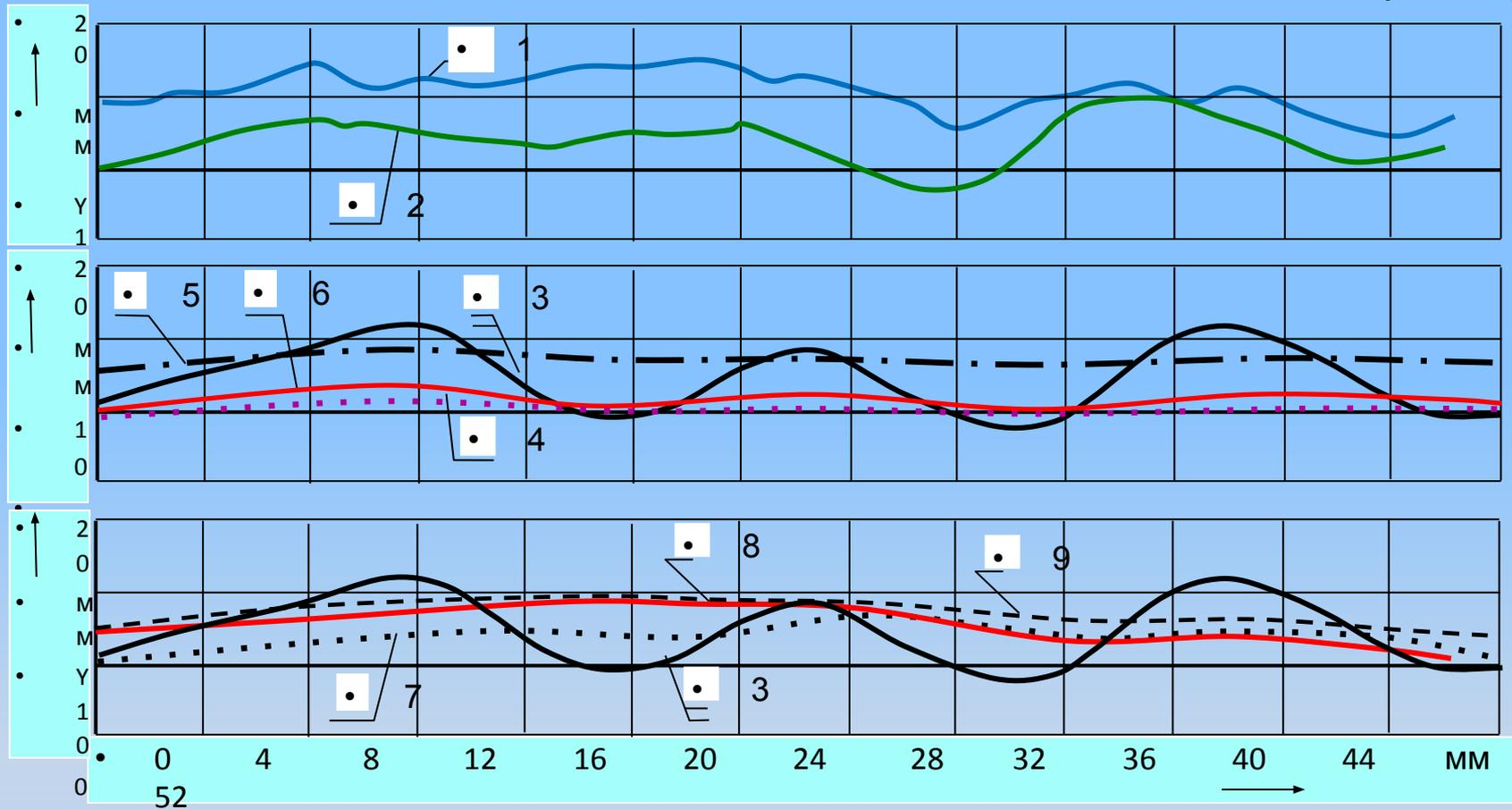
Траектория оси рельсовой колеи: линии: 1 – по уровню ( $z_{II}$ ); 2 – в плане ( $y_{II}$ ).
