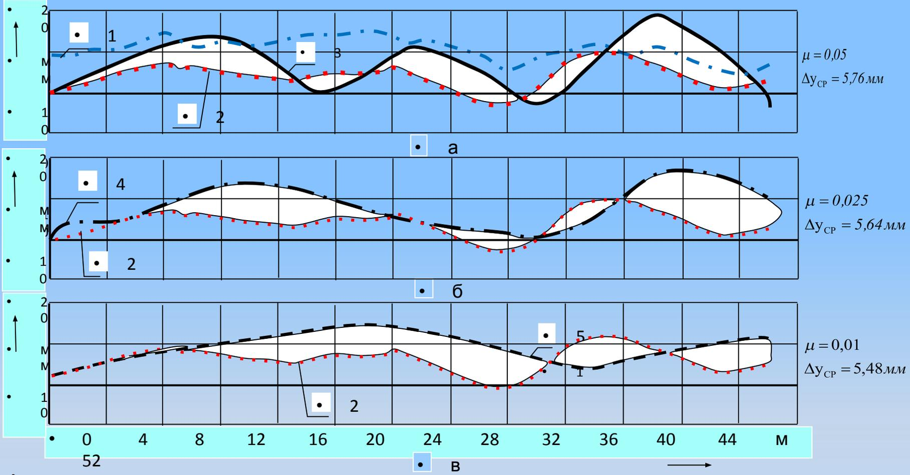
1 – траектория оси рельсовой колеи по уровню ( $z_{\Pi}$ ); 2 – траектория оси рельсовой колеи в плане ( $y_{\Pi}$ ); 3 – движение колесной пары при  $y_0 = 0$  мм и  $\mu = 0,05$  (стандартная конусность); 4 - движения колесной пары при  $\mu = 0,025$ ; 5 - движения колесной пары при  $\mu = 0,01$ .
