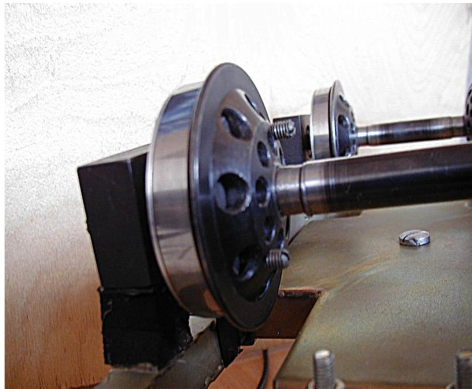
36 Действующий макет полигона для сравнительных испытаний трех вариантов конструкций колесных пар
