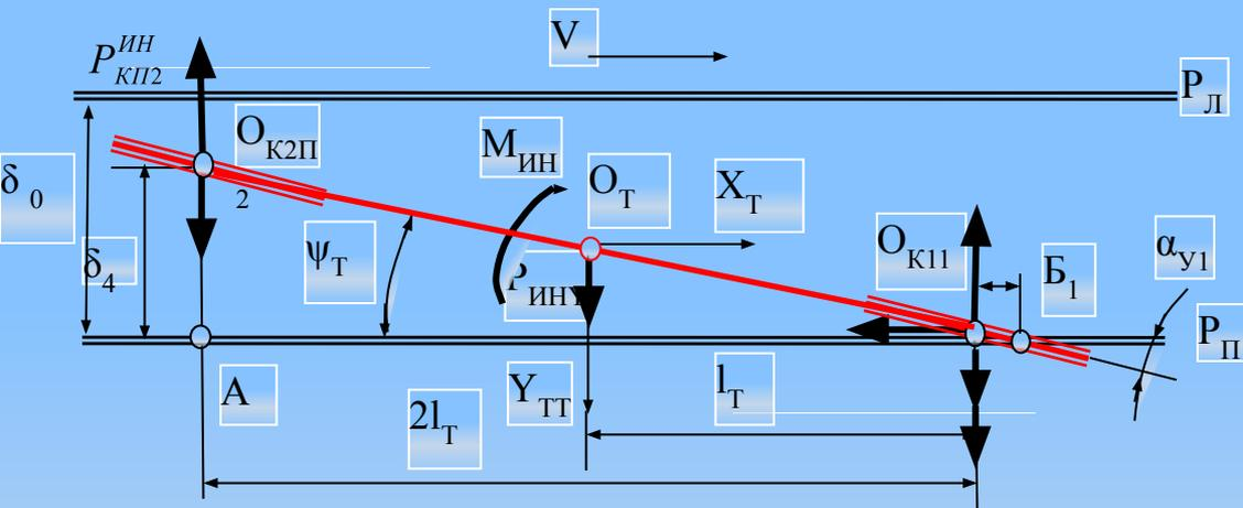
Зависимость длины траектории (трактрисы) второй колесной пары тележки от величины зазора между гребнем и направляющим рельсом.
