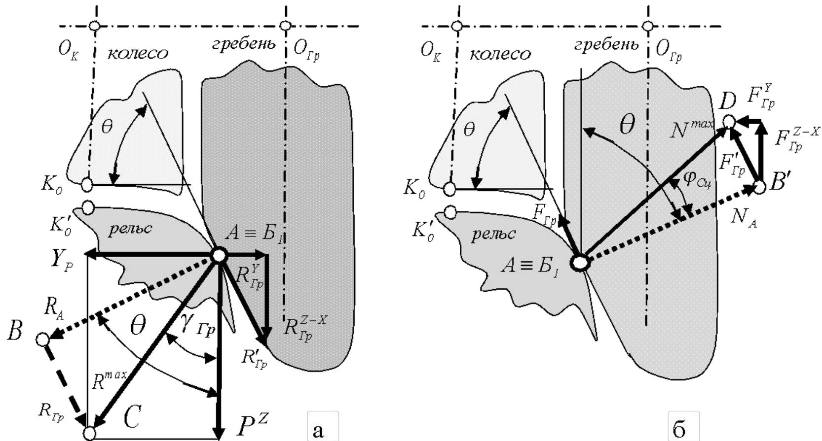
Рисунок 1 – Векторные диаграммы сил в поперечно – вертикальной плоскости в точке контакта ( $B_1$ ) гребня колесной пары и головки рельса: а – внешние силы, действующие на гребень; б – силы нормальной реакции и трения.
