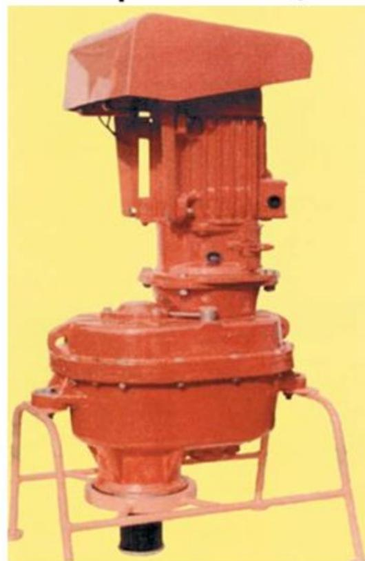
Механизм поворота башенного крана
