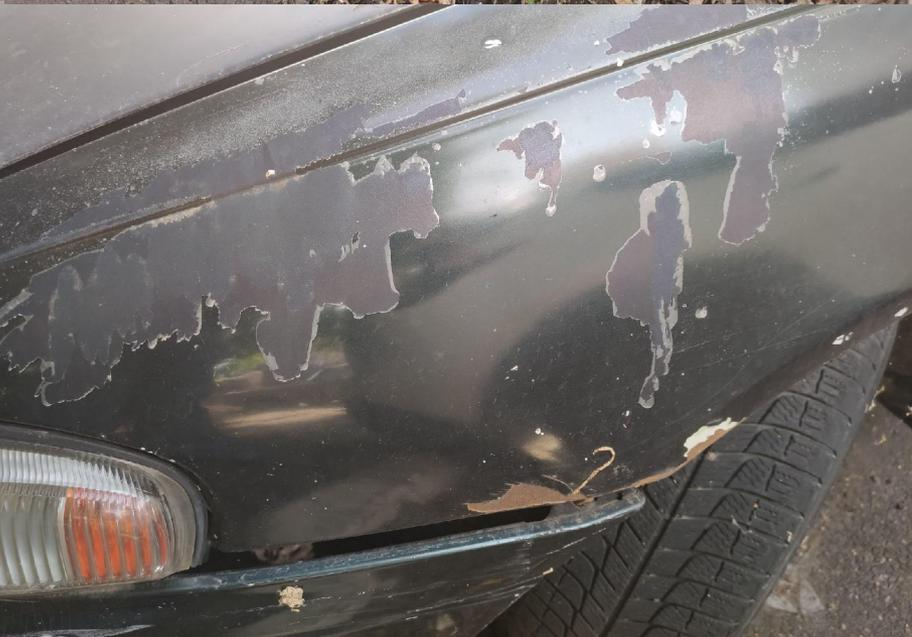
Несомненный плюс хранения под открытым небом — хорошая вентиляция. В сухую, тёплую погоду открыто стоящий автомобиль быстро просыхает — а, как известно, без присутствия влаги коррозии не происходит. А в мороз — быстро промерзает, что также если не полностью останавливает, то сильно замедляет коррозию.
