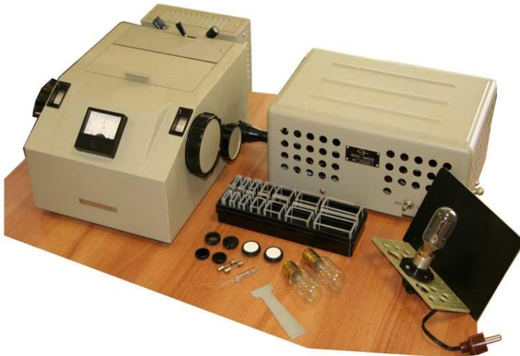
Фотоколориметр электрический ФЭК-56
