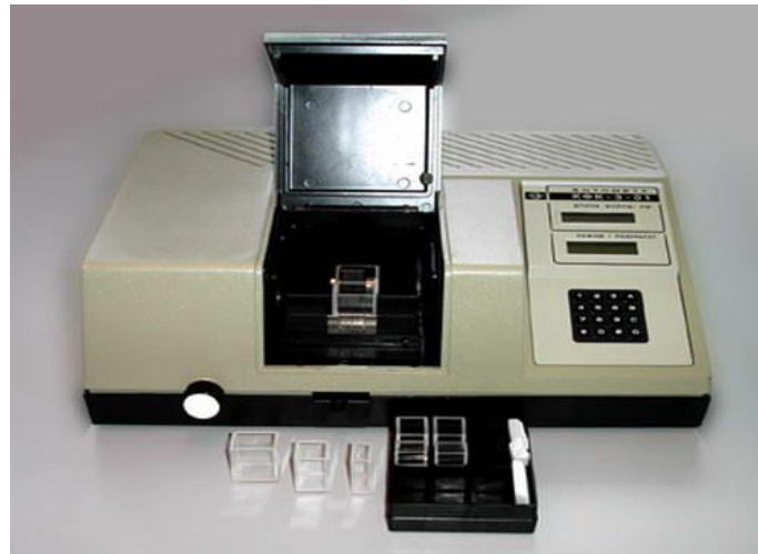
Фотоколориметр электрический ФЭК-56
