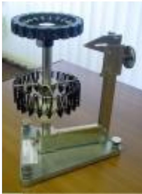
Прибор для определения линейной усадки волокна МТ 705
