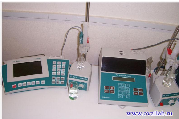
рН метр 780 и Кондуктометр
