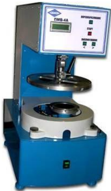
Прибор для определения пиллингуемости тканей МТ-195 (ПМВ-4М).
