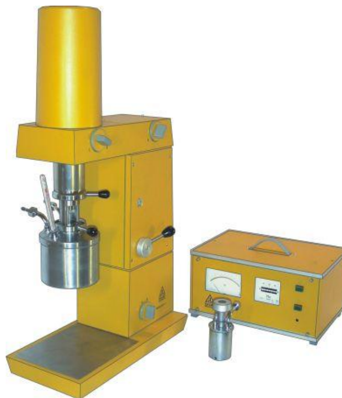
Ротационный вискозиметр модели "Rheotest RV 2.1"
