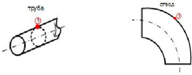
В соответствии с техническим заданием толщина стенки в каждом сечении должна быть измерена **не менее чем в 4 точках по периметру трубы**, одна из которых должна располагаться на нижней образующей, а на отводах – не менее чем в **4-6 точках по выпуклой и вогнутой части:**
