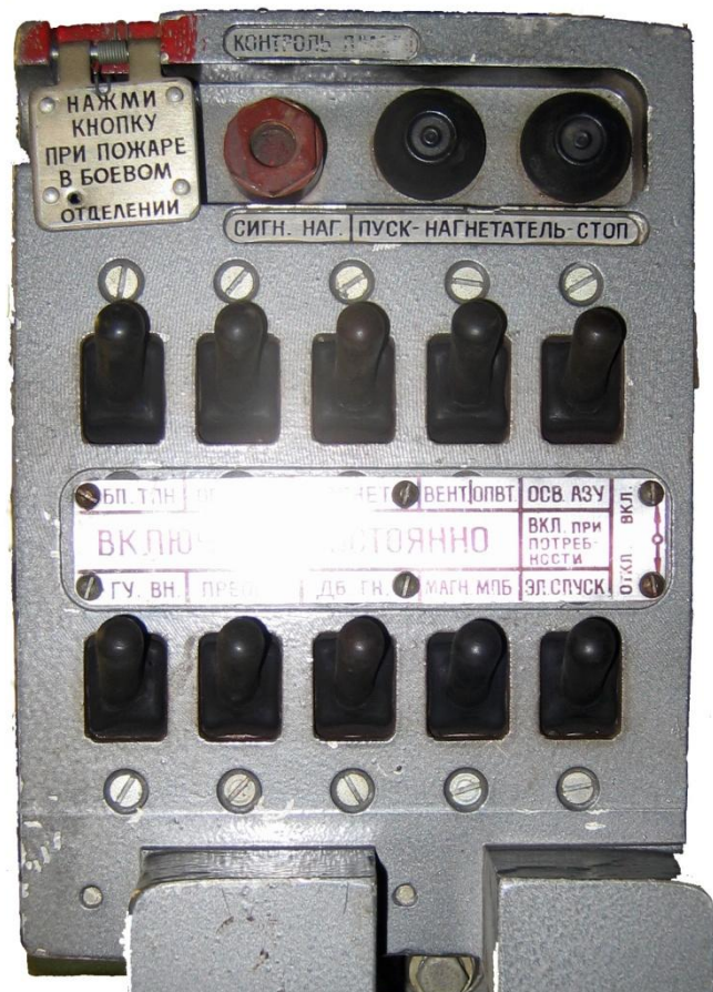
левый распределительный щиток Т-72
