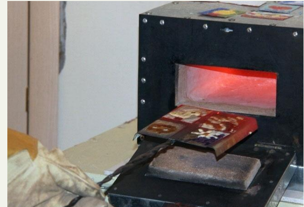
Помещение эмали в печь
