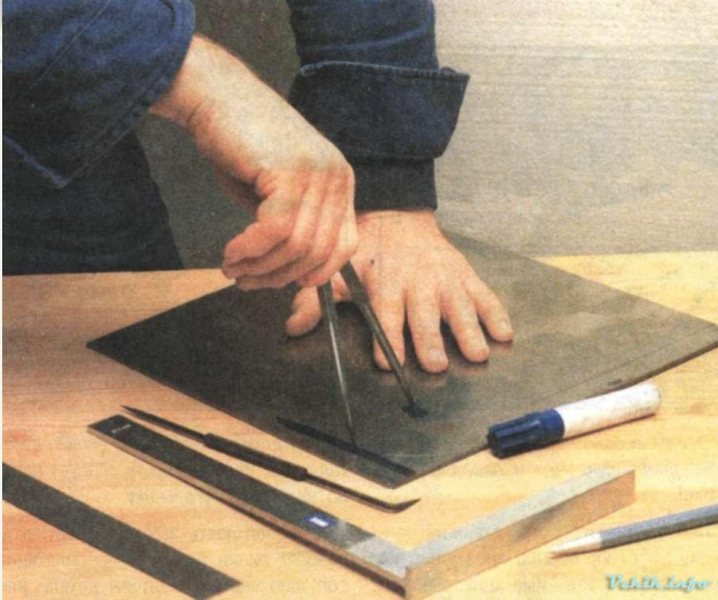
Разметка деталей на металле
