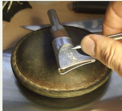
Опорная песчаная подушка
