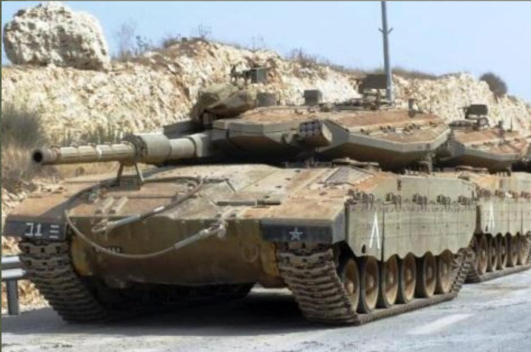
Танк имеет очень оригинальную конструкцию, двигатель танка расположен не сзади, а спереди, что создает дополнительную защиту экипажа от фронтального огня противника. Сзади танка есть люки для экипажа танка, что позволяет экипажу покинуть танк под огнем противника, либо пополнять боеприпасы. В задней части танка есть место для десанта или дополнительного боекомплекта. На танке устанавливается дизельный двигатель американского производства мощностью 1500 л.с.
