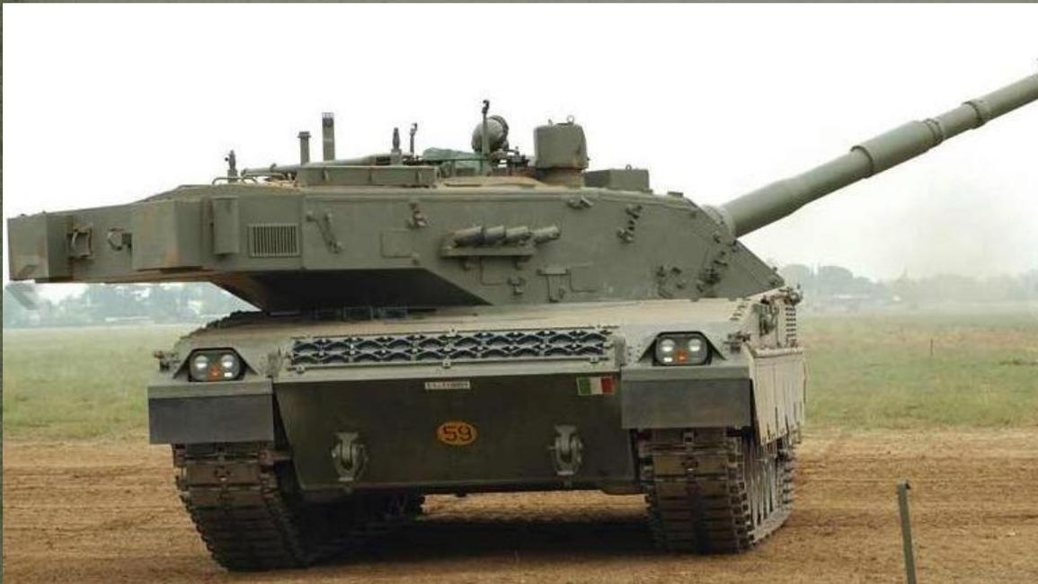
Танк принят на вооружения в 1995 году, в настоящее время производится в единичных экземплярах. Среди недостатков танка первых выпусков – недостаточная удельная мощность двигателя. За свою историю модификаций удалось несколько снизить общий вес танка, таким образом, что бы он весил менее 60 т, танк получил новый более мощный двигатель – 1600 л.с.
