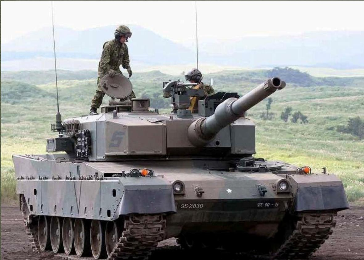
Танк достаточно дорогой на 2008 год имел стоимость 7 500 000\$. Танк принят на вооружении армии Японии в 1990 году. На танк устанавливается немецкая пушка L44. На танке применен автоматический зарядатель снарядов. На танке в качестве брони используется модульная керамика, и композитная броня из высококачественной стали.
