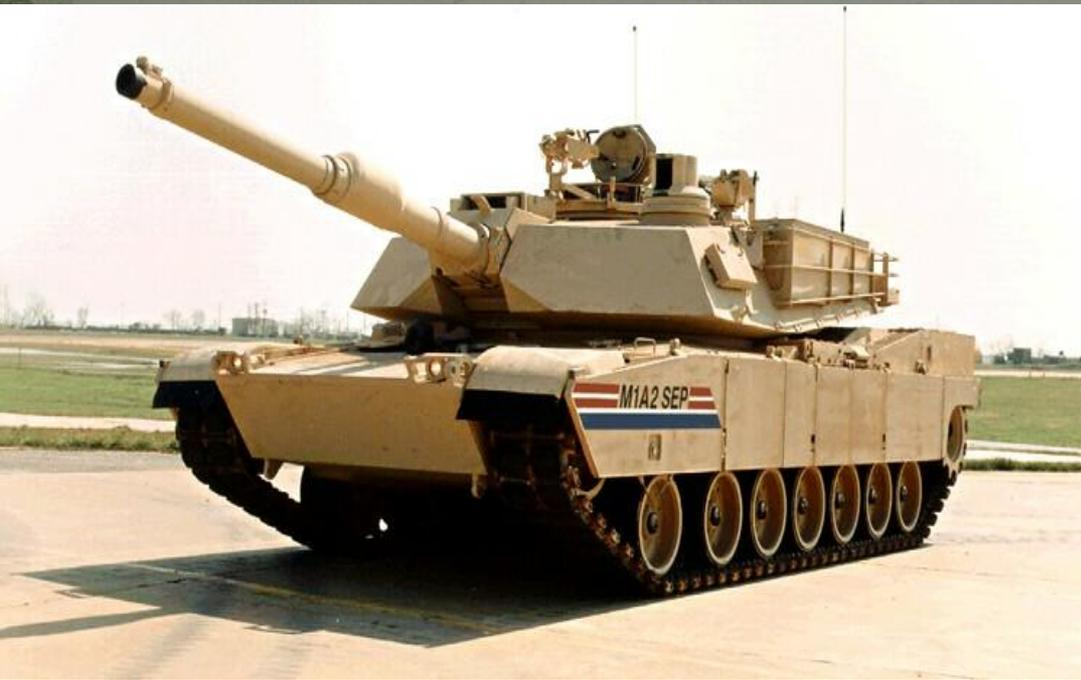
На танк, с самого начала производства устанавливается турбинный двигатель, мощностью 3500 л.с., хотя во всех официальных документах указана мощность 1500 л.с. На танке даже установлен ограничитель мощности и скорости, поскольку полная мощность двигателя просто-напросто рвет гусеницы. С 1990 года танк оснащается дополнительной силовой установкой для обеспечения питания танка электроэнергией на стоянках, что бы не запускать основной двигатель и не использовать аккумуляторные батареи.
